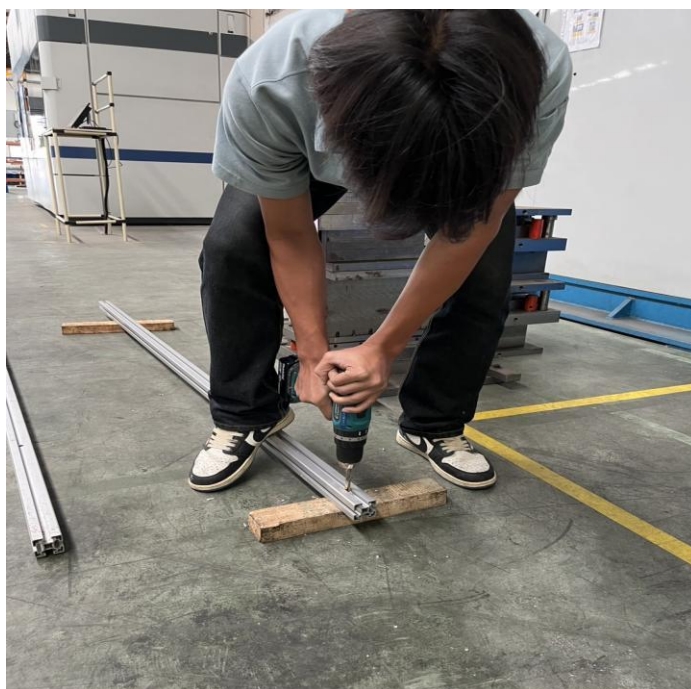
ภาพที่ 3.6.2 ภาพแสดงการเจาะรู Aluminium Profile
