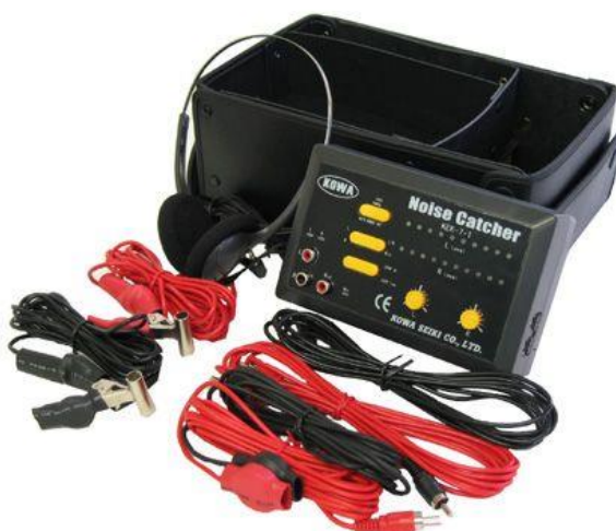
ภาพที่ 2.10 เครื่องมือวิเคราะห์เสียง ( Noise Catcher)
