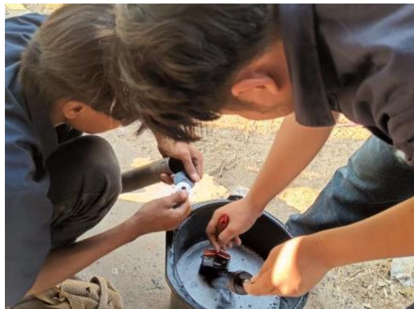
ภาพที่ 2 ขั้นตอนการล้างโซ้คด้วยน้ำมันดีเซล ( ที่มา : นายธนกฤต ผนึกทอง และคณะ 2567 )
