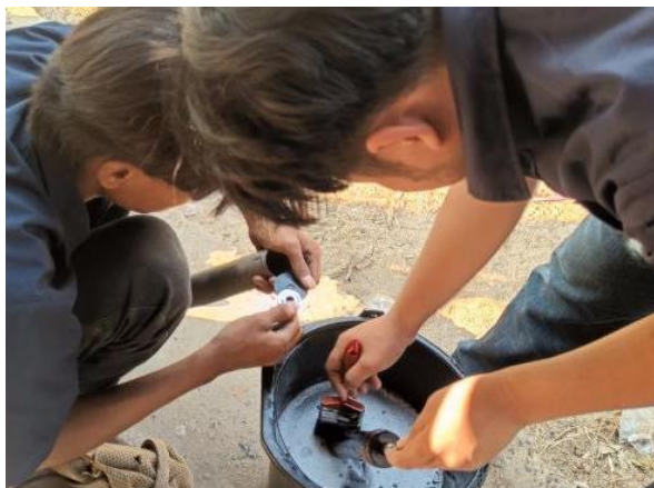
ภาพที่ 2 ขั้นตอนการล้างโซ้ค้อพด้วยน้ำมันดีเซล ( ที่มา : นายธนกฤต ผนึกทอง และคณะ 2567 )
