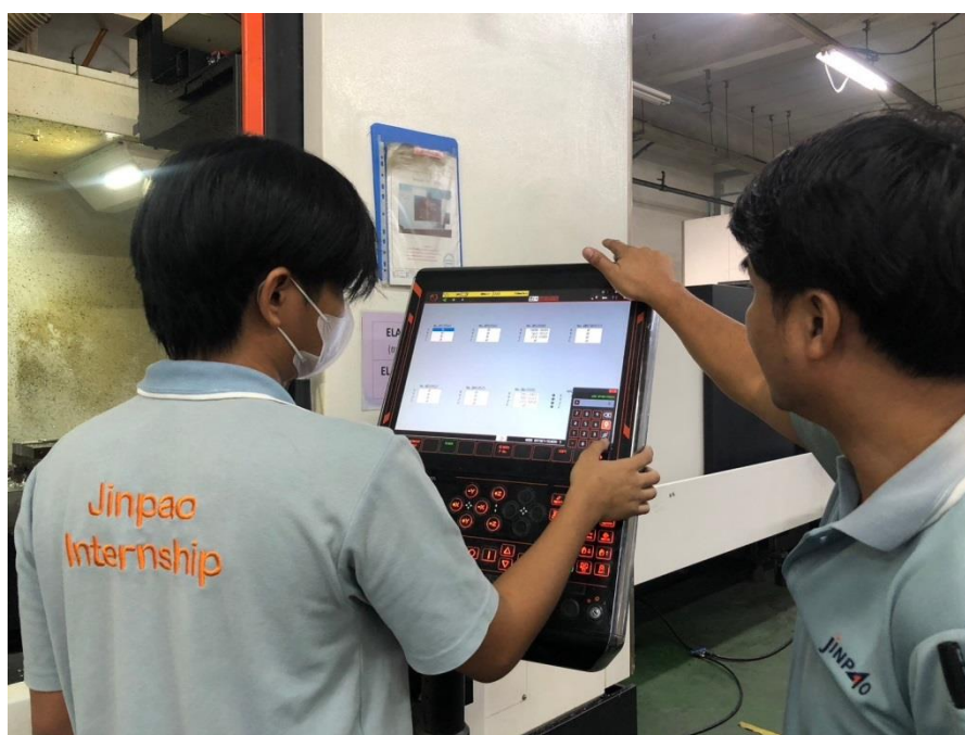
ภาพที่ 8 ภาพแสดงการใส่ค่าWorkในเครื่องจักรCNC Milling
