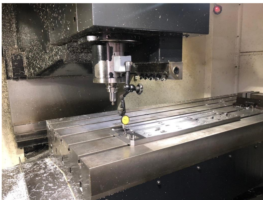
ภาพที่ 6 ภาพแสดงการ Align JIG
