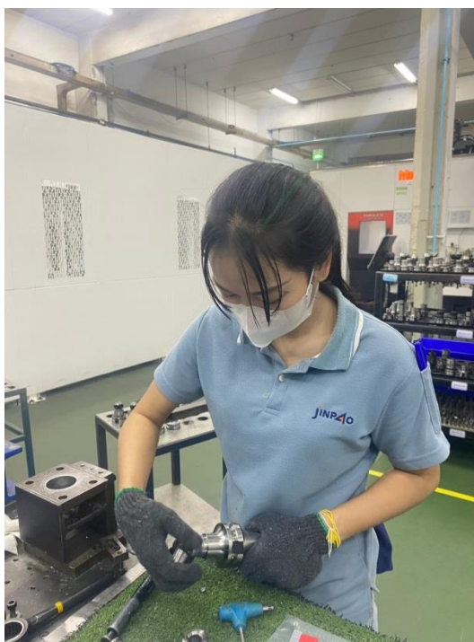
ภาพที่ 1 ภาพแสดงการทำ Tool Holder ให้พอดีกับ Tool
