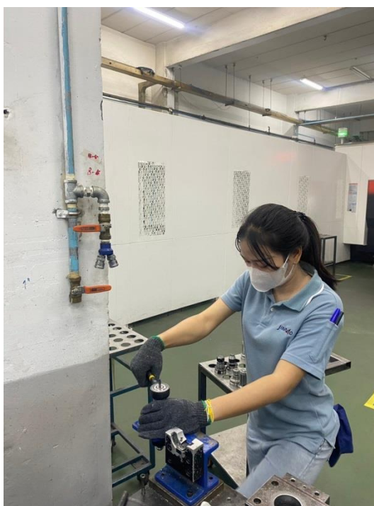
ภาพที่ 2 ภาพแสดงการจับความยาว Tool และล็อก Tool
