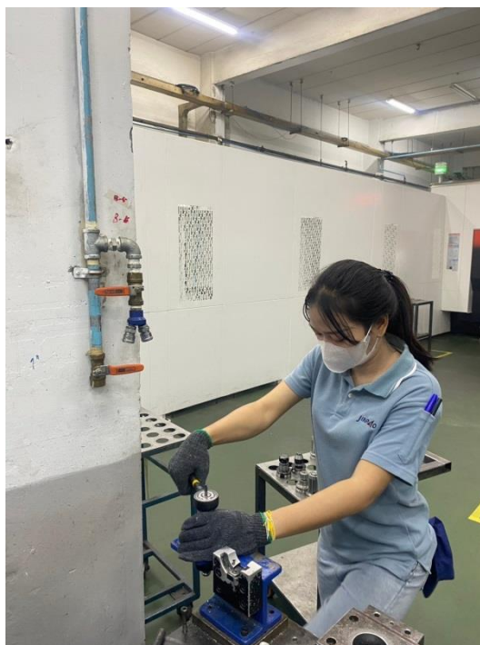
ภาพที่ 3.6.2 ภาพแสดงการจับความยาว Tool และล็อก Tool
