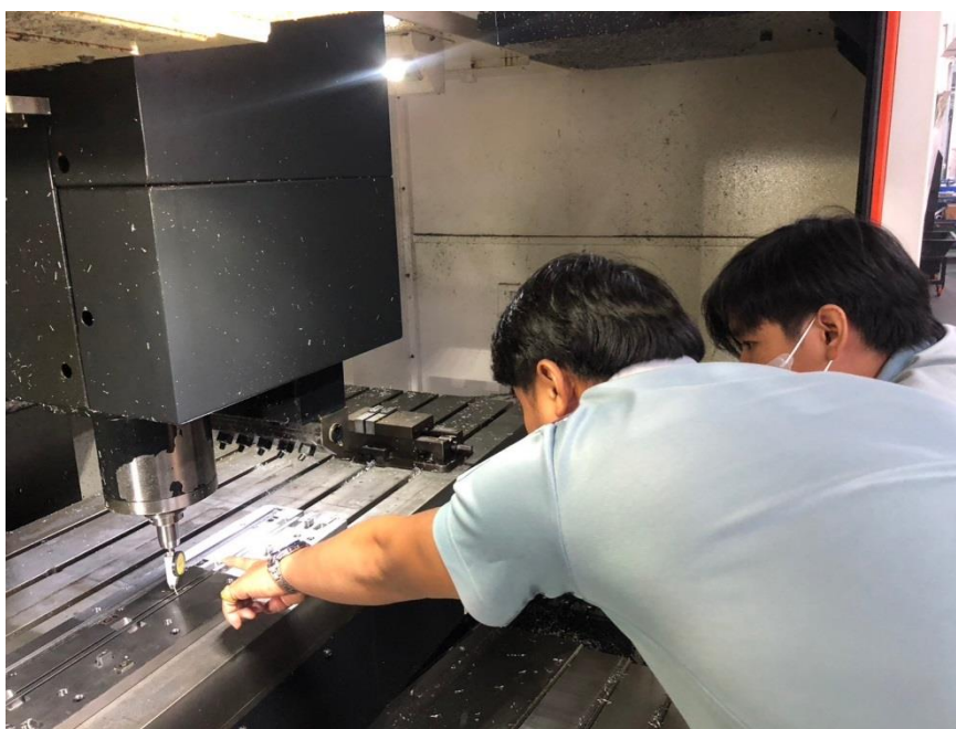
ภาพที่ 7 ภาพแสดงการหาค่า work ด้วย Dyen
