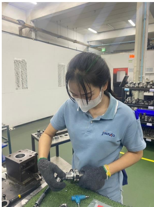
ภาพที่ 3.6.1 ภาพแสดงการหา Tool Holder ให้พอดีกับ Tool
