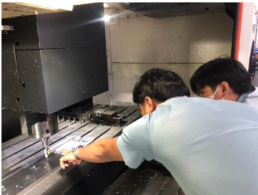
ภาพที่ 3.6.7 ภาพแสดงการหาค่า work ด้วย Dye
