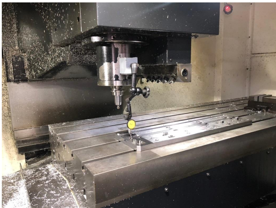
ภาพที่ 3.6.6 ภาพแสดงการ Ailgnment JIG
