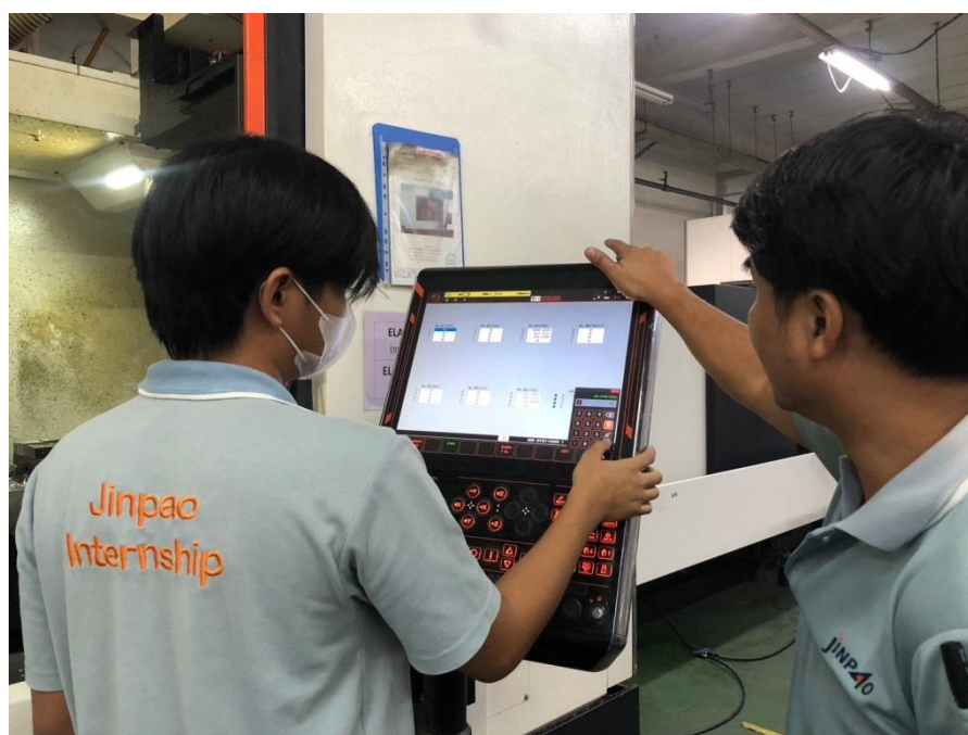
ภาพที่ 3.6.8 ภาพแสดงการใส่ค่าWorkในเครื่องจักรCNC Milling
