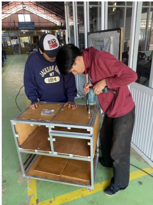
ขั้นตอนที่ 6 วางไม้อัดใส่กับโครงเหล็กและเจาะโดยใช้ดอกสว่านนำร่อง
