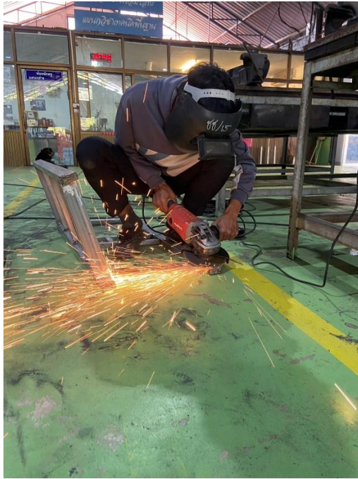
ขั้นตอนที่ 5 ทำการเจียรแนวเชื่อมให้สะอาด
