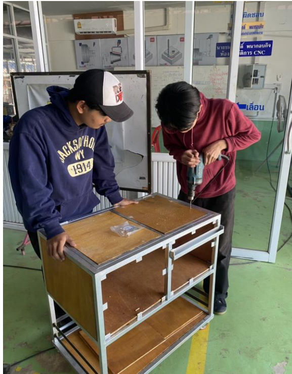
ขั้นตอนที่ 7 ยิงสกรูเข้ากับโครง กล่องเก็บเครื่องมือเคลื่อนที่
