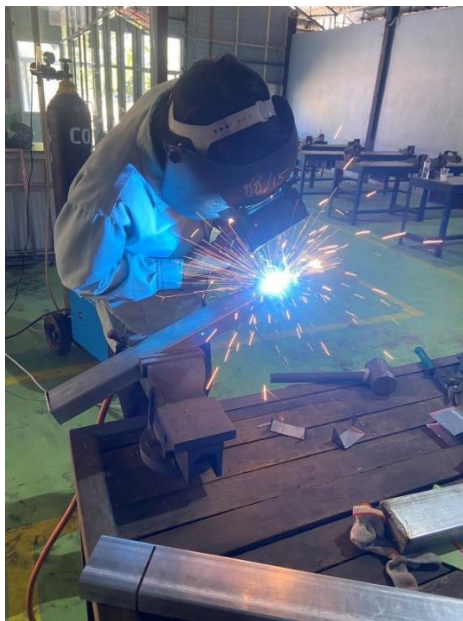
ขั้นตอนที่ 3 เชื่อมโครงเหล็ก กล่องเก็บเครื่องมือเคลื่อนที่
