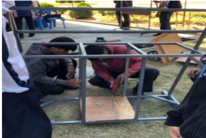
ภาพการดำเนินงานที่ 5 ประกอบชิ้นส่วนแผ่นไม้ (ที่มา : นางสาวชมพูนุช แม่นงาม และคณะ : 2567)
