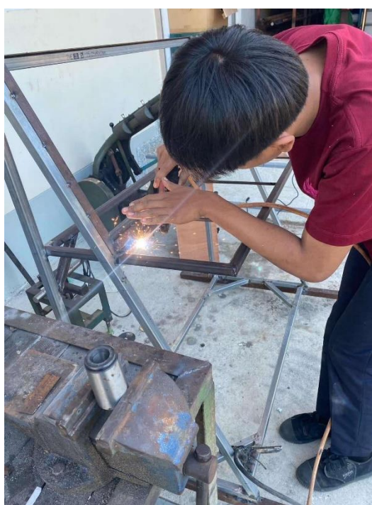
ภาพที่ 3 ขั้นตอนการเชื่อมทำโครงโต๊ะสำหรับวางชุดปฏิบัติการสอนนิวมेटิกส์และไฮดรอลิกส์
