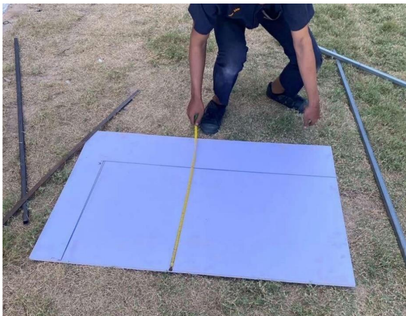
ภาพที่ 4 ขั้นตอนการวัดไม้อัดเพื่อทำชุดปฏิบัติการสอนนิเวติกส์และไฮดรอลิกส์
