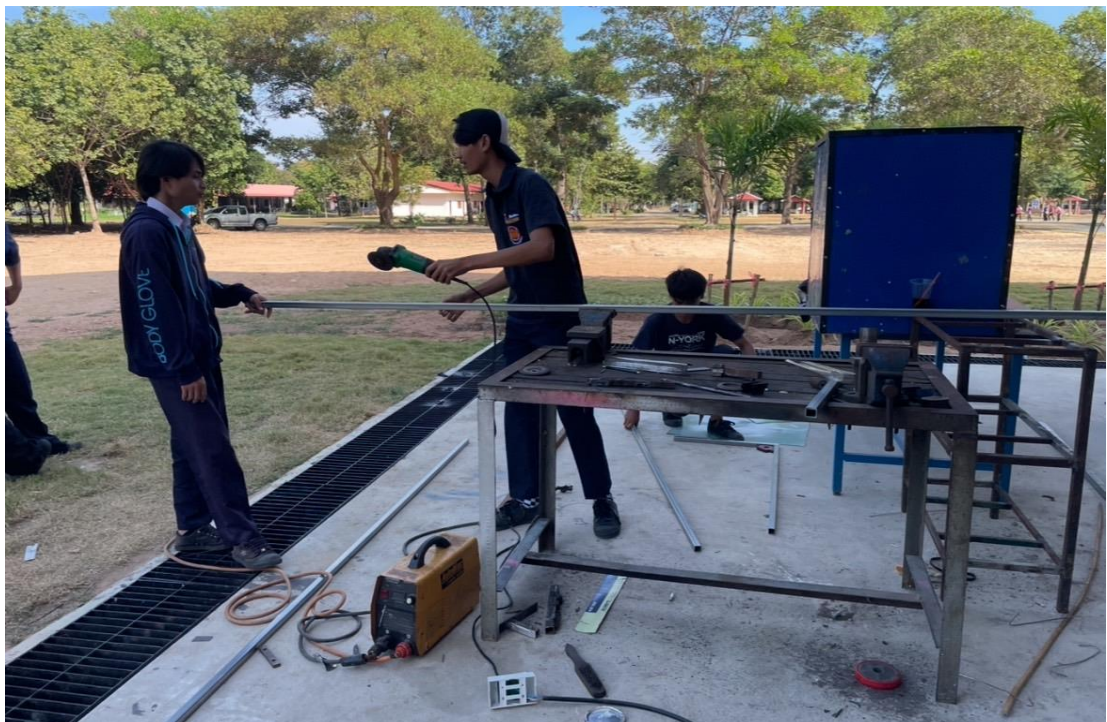
ภาพที่ 2 ตัดเหล็กเพื่อทำโครงตามแบบชุดปฏิบัติการสอนนิเวติกส์และไฮดรอลิกส์
