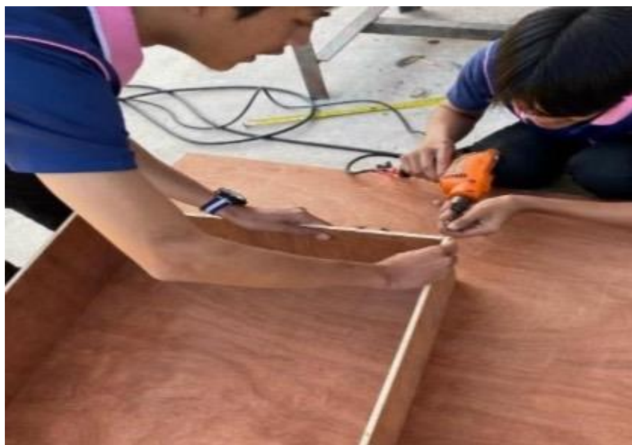
ภาพที่ 5 ขั้นตอนการประกอบไม้อัดเพื่อทำชุดปฏิบัติการสอนนิเวติกส์และไฮดรอลิกส์
