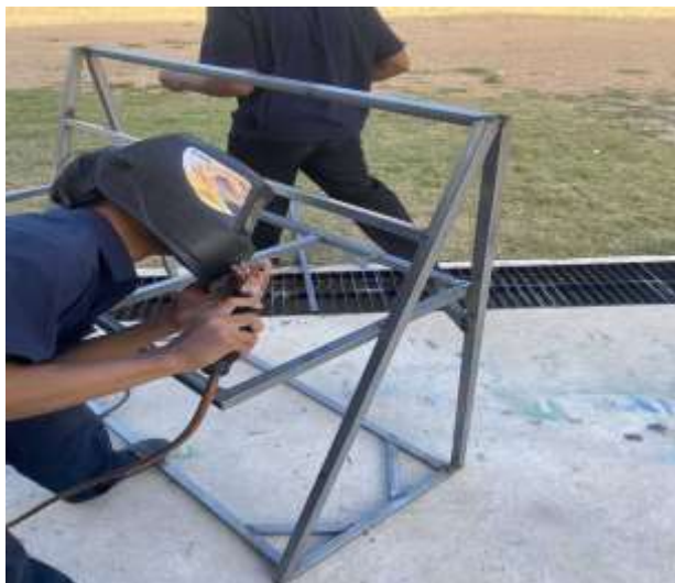
ภาพการดำเนินงานที่ 3 เชื่อมเพื่อขึ้นโครง (ที่มา : นางสาวชมพูนุช แม่นงาม และคณะ : 2567)
