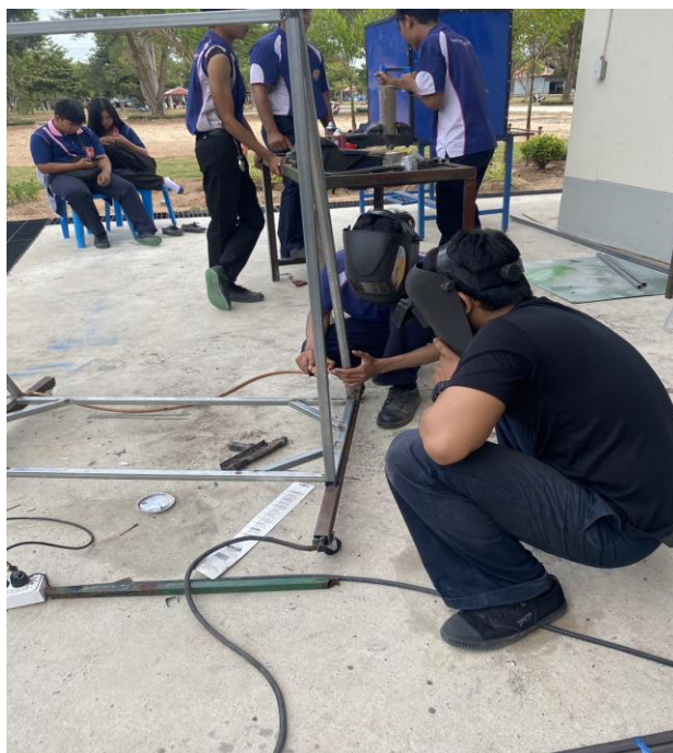
ภาพการดำเนินงานที่ 1 ขั้นตอนการเชื่อมชิ้นโครงโต๊ะสำหรับวางชุดสื่อการสอนนิเวติกส์
