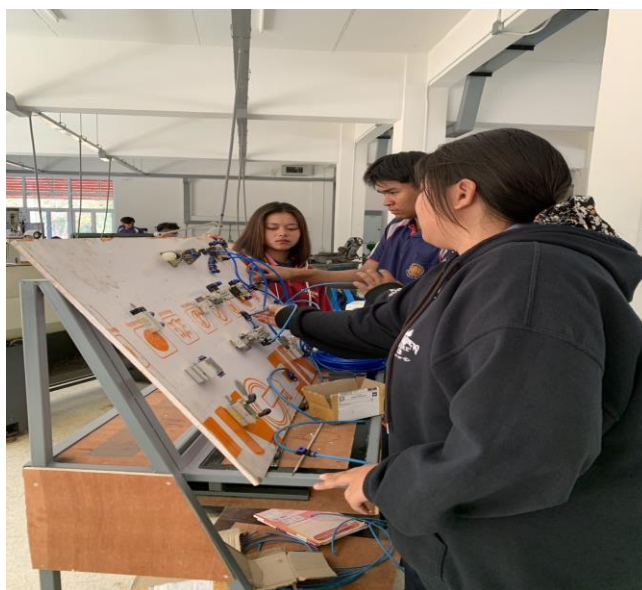
ภาพการดำเนินงานที่ 6 การต่อลมเข้าชุดสื่อการสอนนิวเมติกส์
