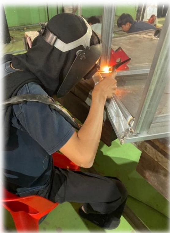
ขั้นตอนที่ 3 ทำการเชื่อมชิ้นโครงรถเข็น
