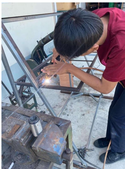
ภาพที่ 3 ขั้นตอนการเชื่อมทำโครงโต๊ะสำหรับวางชุดปฏิบัติการสอนนิวเมติกส์และไฮดรอลิกส์
