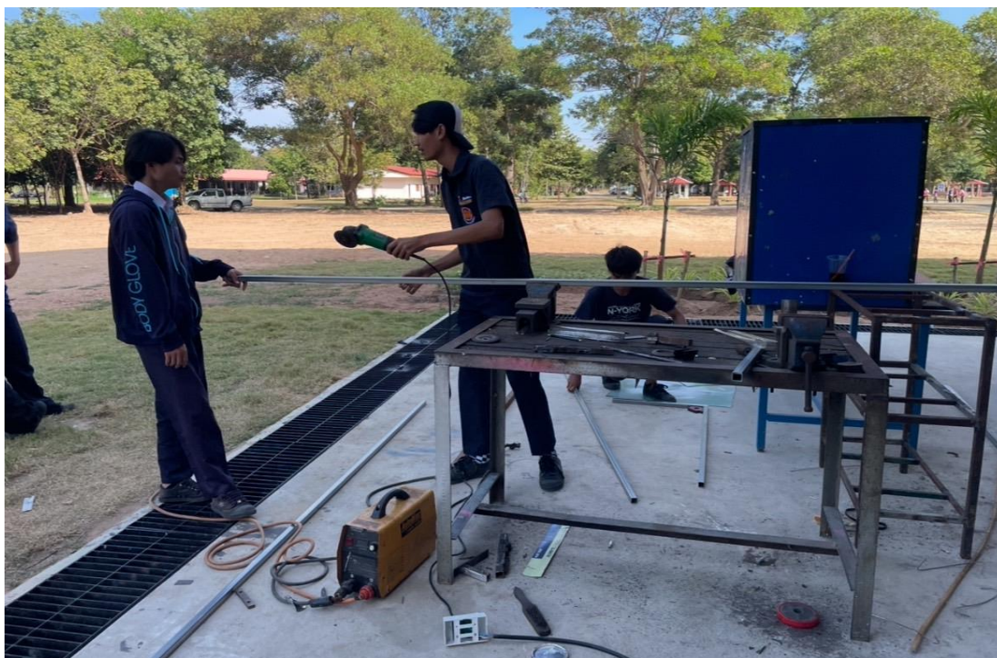
ภาพที่ 2 ตัดเหล็กเพื่อทำโครงตามแบบชุดปฏิบัติการสอนนิเวติกส์และไฮโดรลิกส์
