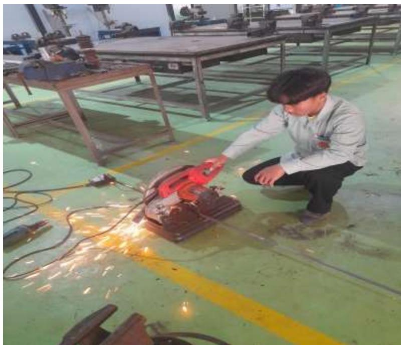
รูปที่ 2 ตัดเหล็กให้ได้ขนาดที่วัดตามแบบ
