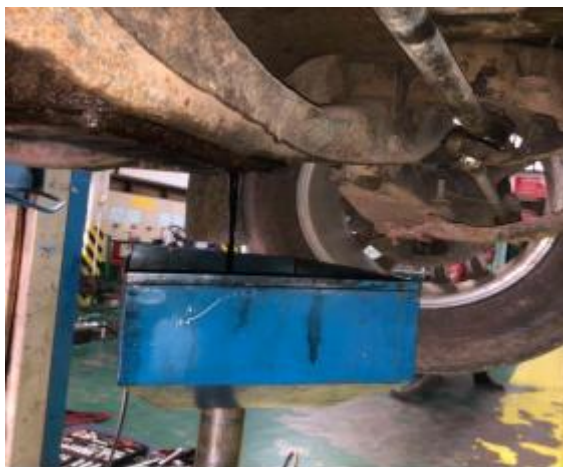
ภาพที่ 3.1 ศึกษาความต้องการของเครื่องยนต์โดยการถ่ายน้ำมันเครื่อง (ที่มา : นายมงคล แก้วสว่าง และคณะ : 2568)
