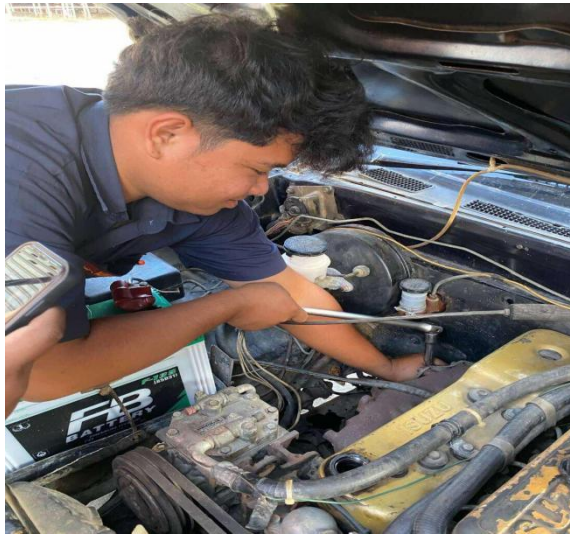
ภาพการดำเนินงานที่ 2 ติดตั้งกรองน้ำมันเครื่อง เพื่อใช้ระบบหล่อลื่น
