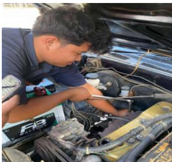
ภาพที่ 3.2 ติดตั้งระบบหล่อลื่นโดยใช้กรองน้ำมันเครื่อง (ที่มา : นายมงคล แก้วสว่าง และคณะ : 2568)
