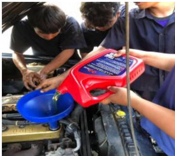
ภาพที่ 3.3 ทดสอบระบบหล่อลื่นและหากพบปัญหาหรือข้อผิดพลาดในการทำงาน (ที่มา : นายมงคล แก้วสว่าง และคณะ : 2568)
