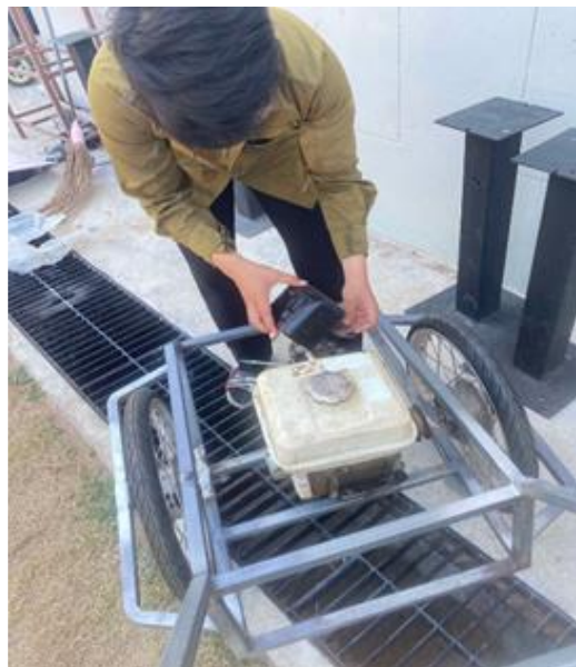
ภาพที่ 3.6 ติดตั้งเครื่องยนต์บนชิ้นงาน
