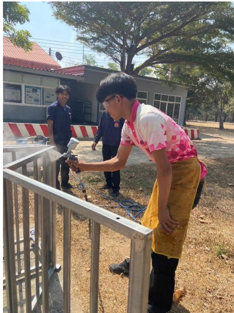
ขั้นตอนที่ 3 ทำการพ่นสีโครงสร้างเก่าอีที่เชื่อมไว้
