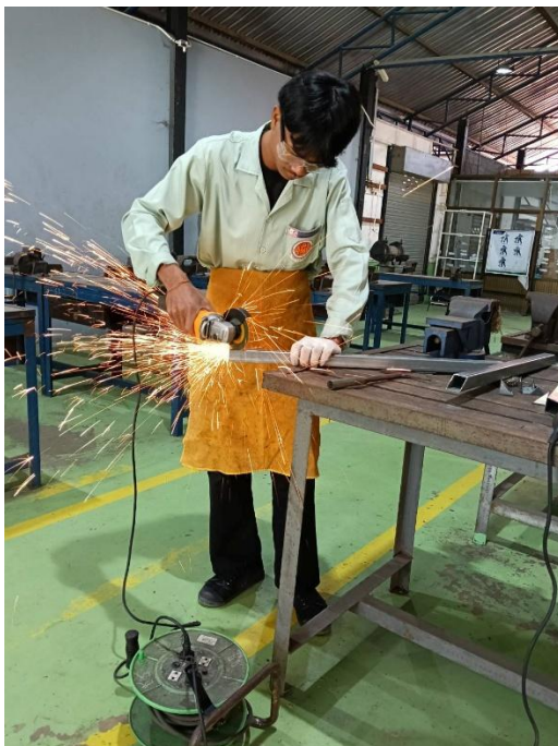
ขั้นตอนที่ 1 ทำการตัดเหล็ก
