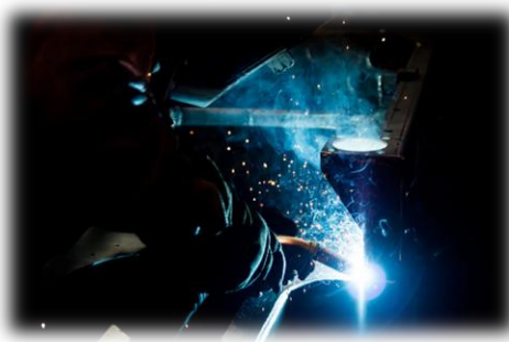
รูปที่ 2.9 กระบวนการเชื่อม MIG ( ที่มา https://sa-thai.com )
