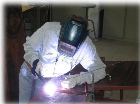
รูปที่ 2.5 กระบวนการเชื่อมทิก ( ที่มา https://th.wikipedia.org/wiki/ )
