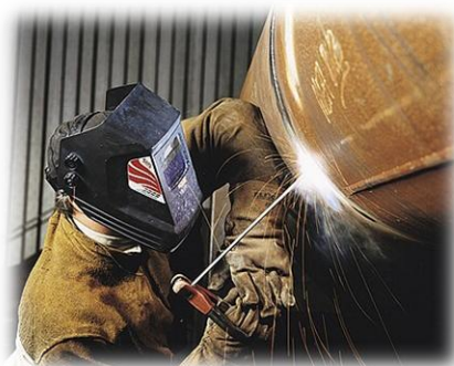
รูปที่ 2.4 กระบวนการเชื่อมไฟฟ้า ( ที่มา https://th.wikipedia.org/wiki/ )
