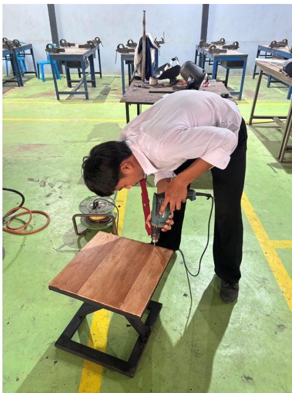
ขั้นตอนที่ 6 ทำการประกอบแผ่นไว้นเข้ากับโครงสร้างเก้าอี้
