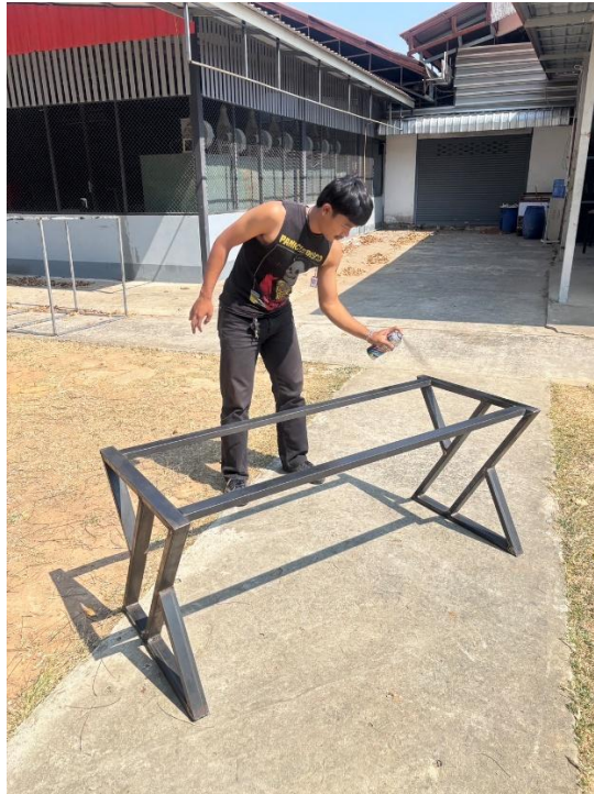
ขั้นตอนที่ 3 ทำการพ่นสีโครงสร้างโต๊ะ
