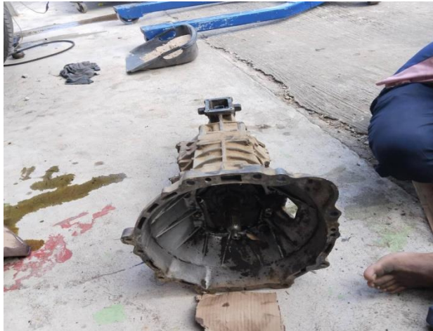
ภาพที่ 3.1 ยกเกียร์ลงจากรถยนต์ ( ที่มา : นายเผ่าลาภ จันทรดำ และคณะ :2568 )
