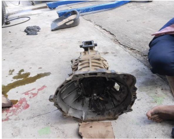
ภาพที่ 3.1 ยกเกียร์ลงจากรถยนต์ ( ที่มา : นายเผ่าลาภ จันทร์ดำ และคณะ :2568 )
