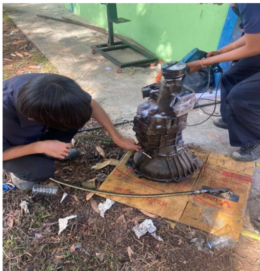
ภาพที่ 3.2 ทำความสะอาดภายนอกเกียร์ ( ที่มา : นายเผ่าลาภ จันทร์ดำ และคณะ :2568 )
