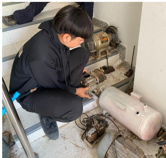
ภาพการดำเนินงานที่ 3.1 ศึกษาระบบของปั๊มลม และตรวจสอบอุปกรณ์ที่ชำรุดเสียหาย ( ที่มา : นายชิษณุชา นนทร์ธรรม และคณะ : 2567 )
