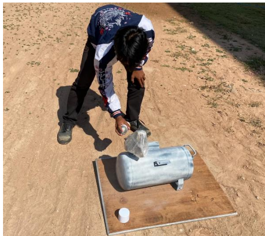
ภาพการดำเนินงานที่ 2 พ่นสีถังลม ( ที่มา : นายชิษณุชา นนทร์ธรรม และคณะ : 2567 )
