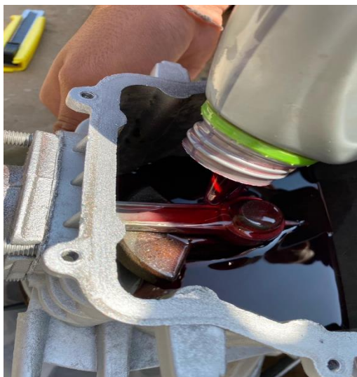
ภาพการดำเนินงานที่ 3.3 เติมน้ำมันเครื่องใส่ ( ที่มา : นายชิษณุชา นนท์ธรรม และคณะ : 2567 )
