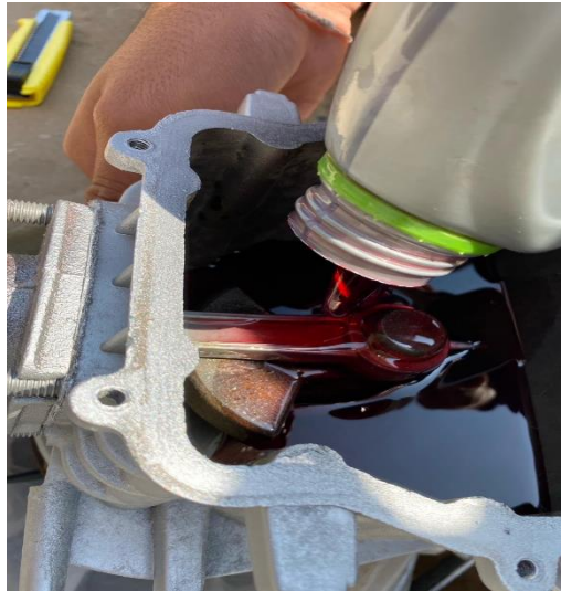
ภาพการดำเนินงานที่ 3 เติมน้ำมันเครื่องใส่ ( ที่มา : นายชิษณุชา นนท์ธรรม และคณะ : 2567 )
