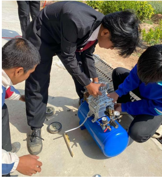
ภาพการดำเนินงานที่ 3.4 ประกอบปั๊มลม ( ที่มา : นายชิษณุชา นนท์ธรรม และคณะ : 2567 )
