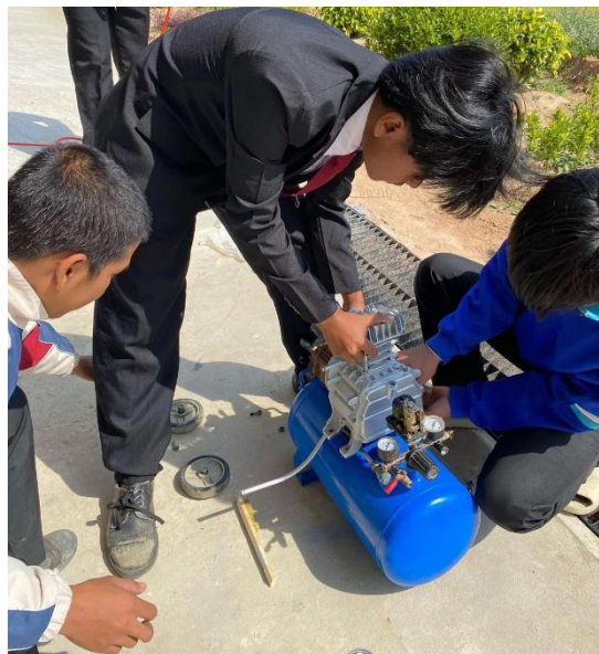
ภาพการดำเนินงานที่ 4 ประกอบปั้มลม ( ที่มา : นายชิษณุชา นนท์ธรรม และคณะ : 2567 )
