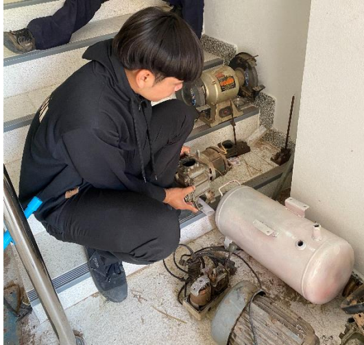
ภาพการดำเนินงานที่ 1 ศึกษาาระบบของปั้มลม และตรวจสอบอุปกรณ์ที่ชำรุดเสียหาย ( ที่มา : นายชิษณุชา นนทร์ธรรม และคณะ : 2567 )
