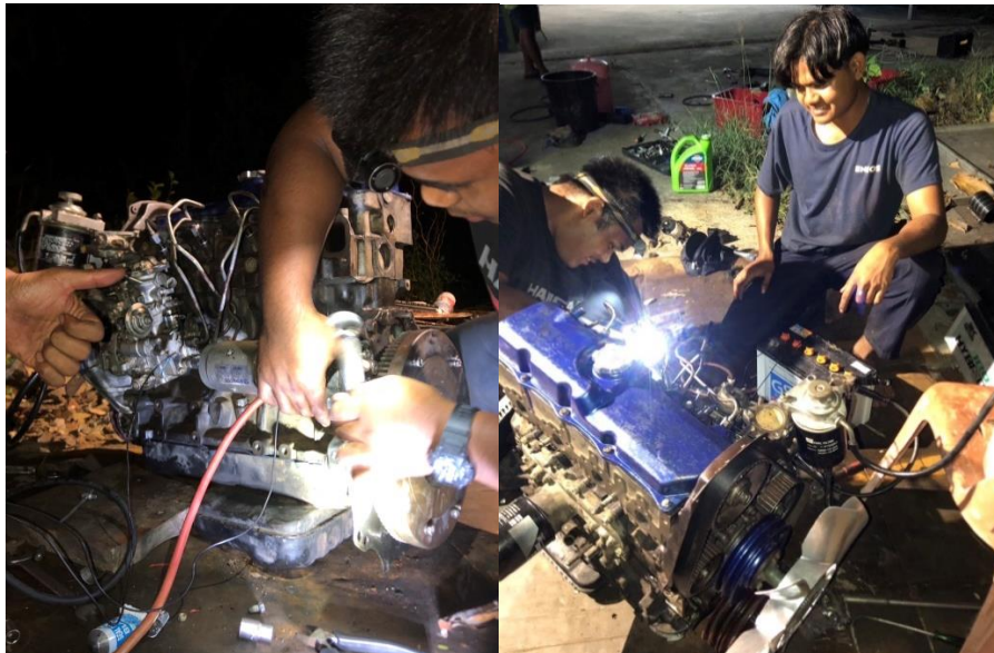
ภาพการดำเนินงานที่ 6 สตาร์ทเครื่องเช็คการทำงานของเครื่องยนต์ ( ที่มา : นายณัฐพล เครือวัลย์ และคณะ : 2568 )
