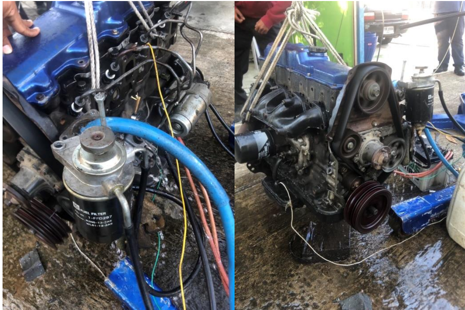
ภาพการดำเนินงานที่ 7 สตาร์ทเครื่องทำการรันอินเครื่องยนต์ให้ขึ้นส่วนภายใน ในขับเคลื่อนได้อย่างเข้าที่ ( ที่มา : นายณัฐพล เครือวัลย์ และคณะ : 2568 )
