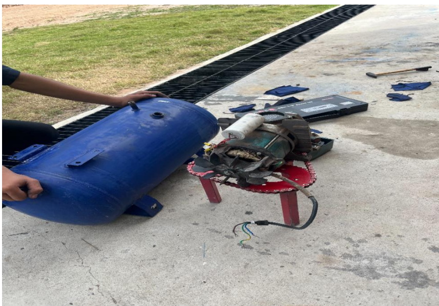
ภาพที่ 3.3 ขัดถังลมเพื่อจะนำไปพ่นสีใหม่ (ที่มา: นายนพรัตน์ หนูนเลิศ และคณะ : 2567)
