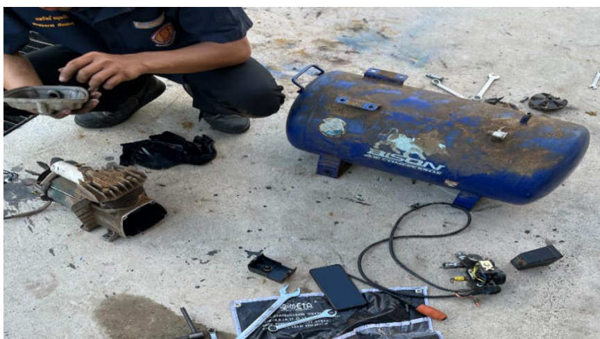
ภาพที่ 3.1 ถอดชิ้นส่วนออกมาเพื่อหาจุดที่ต้องซ่อมบำรุง
