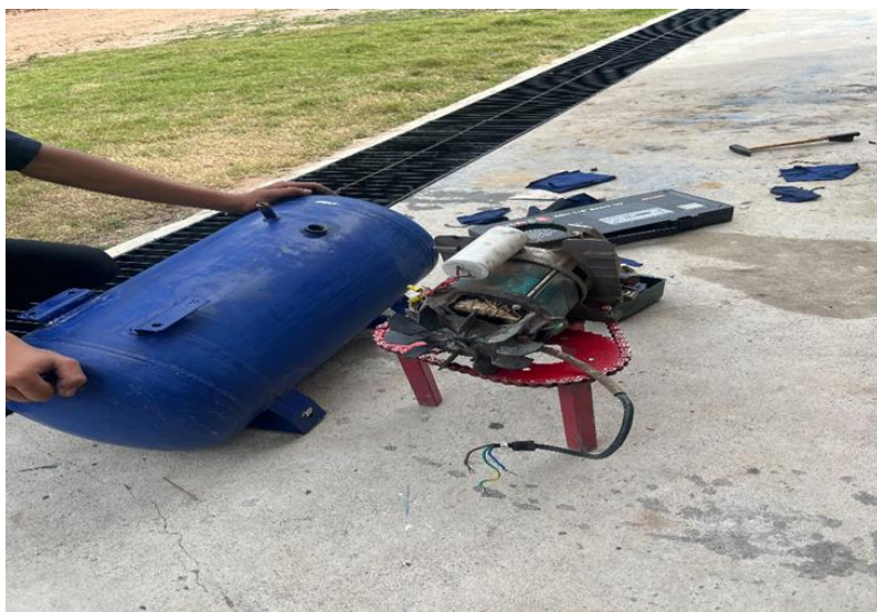
ขัดถังลมเพื่อนำไปพ่นสีใหม่
