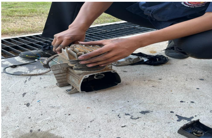
ภาพที่ 3.2 การเช็คหัวลูกสูบว่ายังทำงานปกติอยู่หรือไม่ (ที่มา: นายนพรัตน์ หนูนเลิศ และคณะ : 2567)
