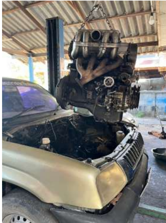
รูปภาพที่ 4.23 ยกเครื่องใส่บอดีรถ
