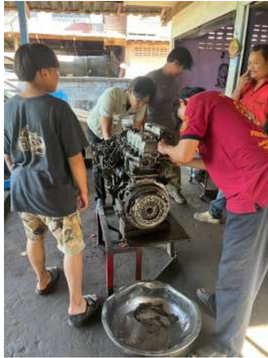
รูปภาพที่ 4.21 ปิดฝาครอบวาล์วแล้วยกขึ้นประกอบกับตัวรถ
