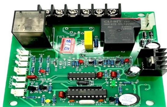
ภาพที่ 2.5 แผงวงจรควบคุมการทำงาน (ที่มา: นายวุฒิชัย วิมูล คณะผู้จัดทำ 2567)
