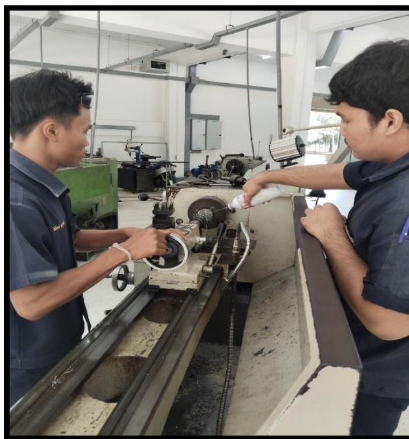
รูปที่ 3.3 การกลึงเหล็กยึดเพลลาเข้ากับสเตอร์ (ที่มา:นายนิพัฒน์ บุญวัฒน์ พร้อมคณะผู้จัดทำ 2567)
