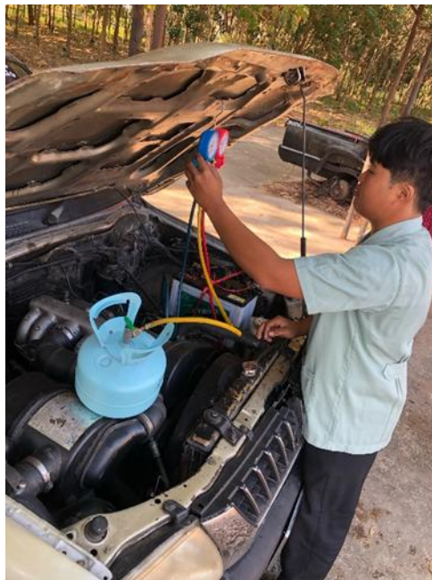
ภาพที่ 5.5 การเติมน้ำยาแอร์เข้าระบบ
