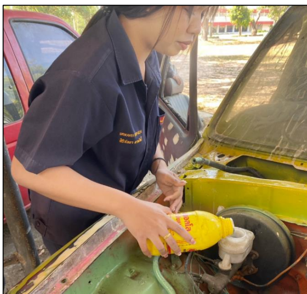
ภาพการดำเนินงานที่ 3.8 เทน้ำมันลงใส่กระปุกน้ำมันเบรก ( ที่มา : นางสาวศิริกัลยา ดาวผักชี และคณะ : 2567 )
