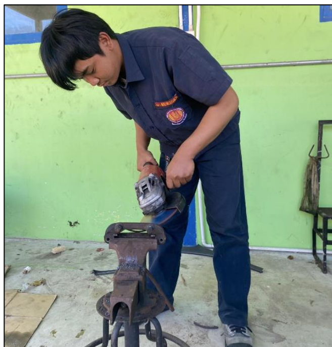
ภาพการดำเนินงานที่ 3.5 เจียโครงเสื่อปัมเบรก เพื่อไม่ให้ติดกับดุมล้อ ( ที่มา : นางสาวศิริกัลยา ดาวผักชี และคณะ : 2567 )
