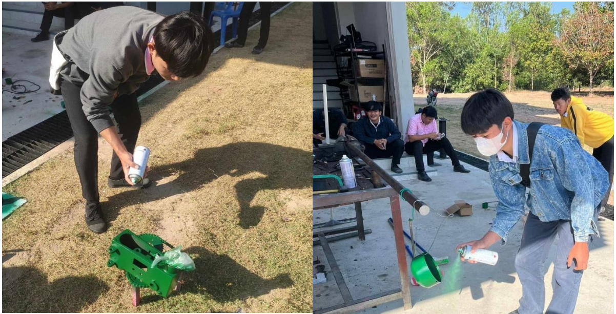
ภาพการดำเนินงานที่ 3.2 ลงสีตัวประกอบหัวเครื่องเจาะ และฝาครอบมอเตอร์ ( ที่มา : นายตรีทศ ปัดทาศรี และคณะ : 2567 )
