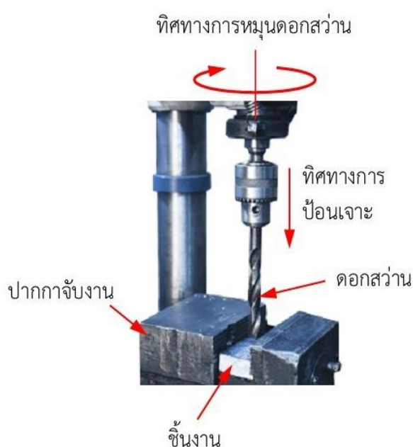
ภาพที่ 2.7 หลักการทำงานของเครื่องเจาะตั้งพื้น
