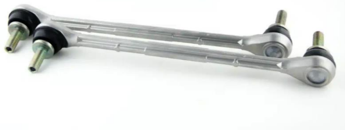
รูปภาพที่ 4. แสดงลูกหมากกันโคลง (stabilizer ball joint)
