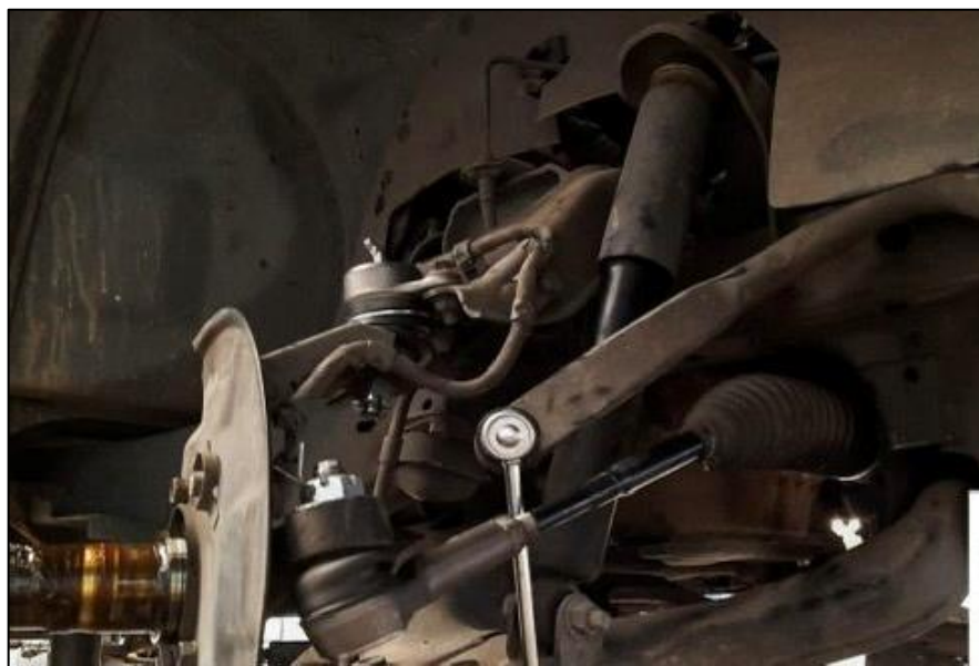
รูปภาพที่4. แสดงภาพการประกอบโช้คอัพ
