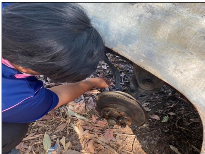
รูปภาพที่5. แสดงภาพการประกอบลูกหมากแร็ค
