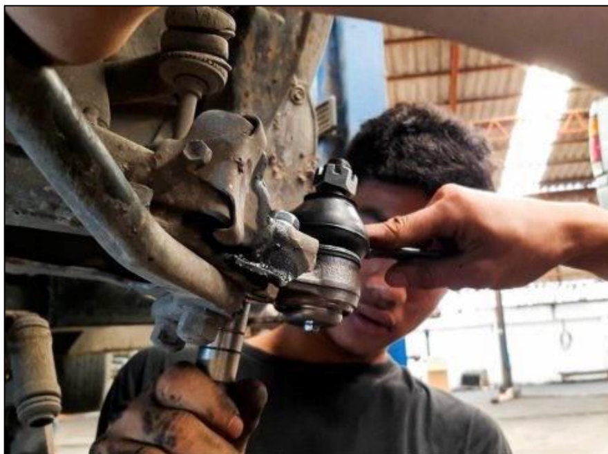
รูปภาพที่3. แสดงภาพการประกอบลูกหมากปีกนกบน
