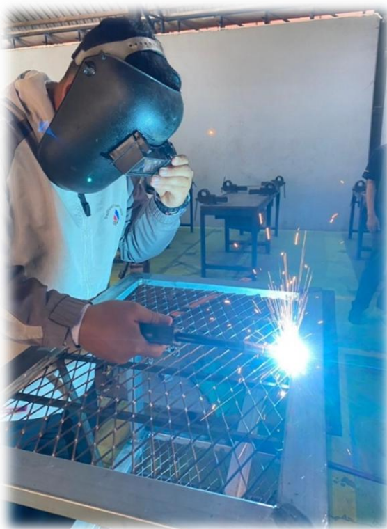
ขั้นตอนที่ 4 ทำการเชื่อมตะแกรงเข้ากับรถเข็น
