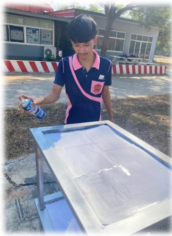
ขั้นตอนที่ 7 ทำการพ่นสีโครงสร้างเงิน
