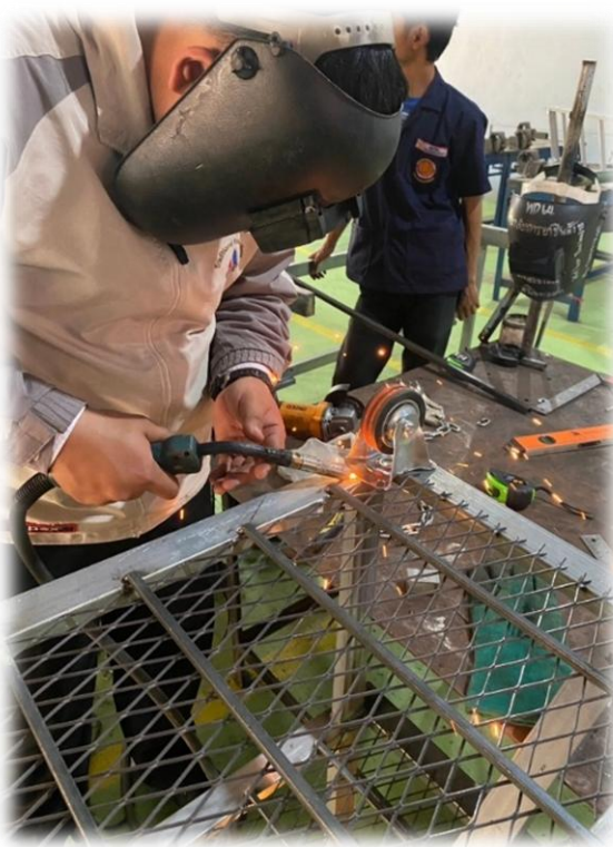
ขั้นตอนที่ 5 ทำการเชื่อมล้อยเข้ากับรถเข็น
