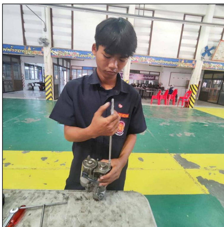
ขั้นตอนที่ 4 เปลี่ยนชิ้นส่วนที่เสียแล้วประกอบไดสตาร์ทเหมือนเดิม
