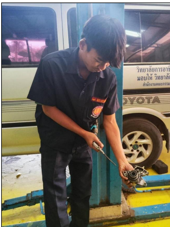
ขั้นตอนที่ 3 ล้างทำความสะอาดชิ้นส่วนไคสตาร์ท
