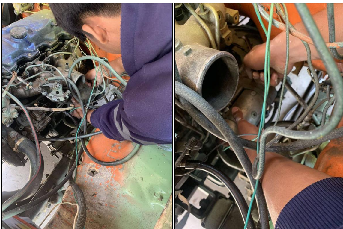
ขั้นตอนที่ 1 ถอดไคสตาร์ทออกจากเครื่องยนต์
