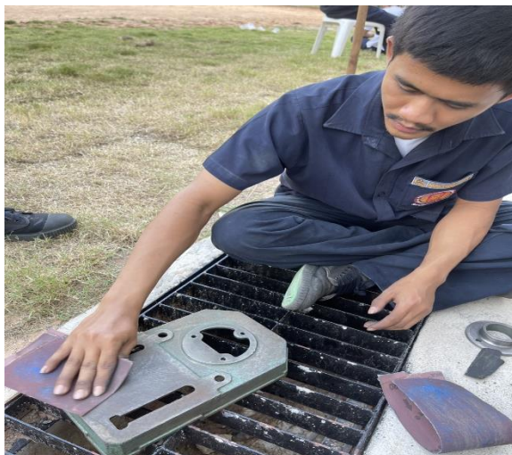
ภาพที่ 3.2 ขั้นตอนในการขัดชิ้นงานเพื่อทำสี ( ที่มา : นายธราเทพ ฝายมอญ และคณะ : 2567 )
