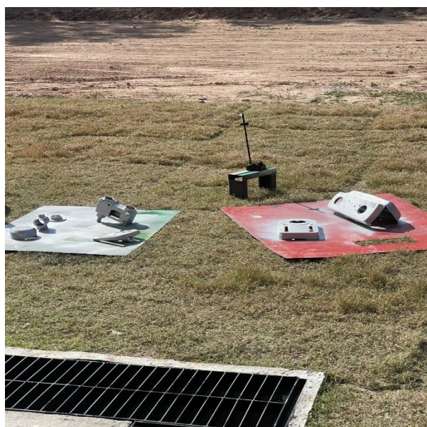
ภาพที่ 3.3 ขั้นตอนการตากสีให้แห้งหลังจากพ่นสีเสร็จ ( ที่มา : นายธราเทพ ฝายมอญ และคณะ : 2567 )
