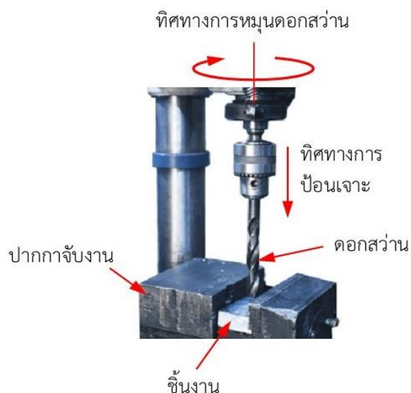
ภาพที่ 2.9 หลักการทำงานของเครื่องเจาะตั้งพื้น
