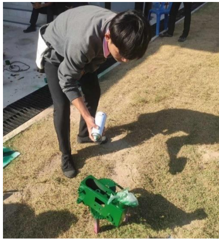
ภาพที่ 3.2 ลงสีตัวประกอบหัวเครื่องเจาะ และฝาครอบมอเตอร์
