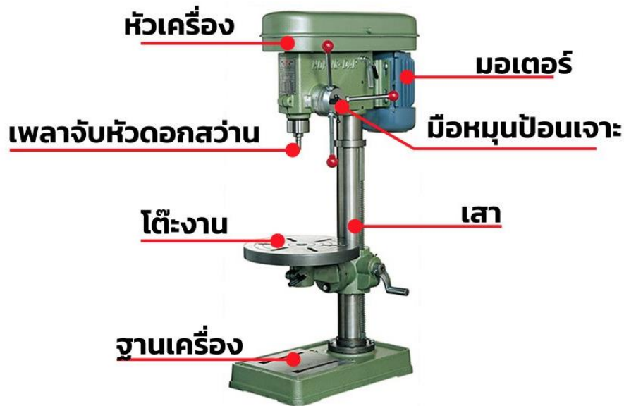
ภาพที่ 2.10 ส่วนประกอบที่สำคัญของเครื่องเจาะตั้งพื้น
