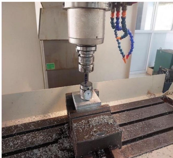
รูปภาพที่ 3.40 การตั้งค่าดอกกัดชิ้นงาน ( ที่มา : นายองศา เลิศงาม และคณะ, 2567 )
