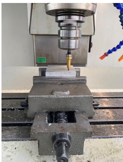
ดำเนินงานรูปภาพที่ 26 การตั้งศูนย์ของชิ้นงาน ( ที่มา : นายภาสกร หิงไธสง และคณะ, 2567 )
