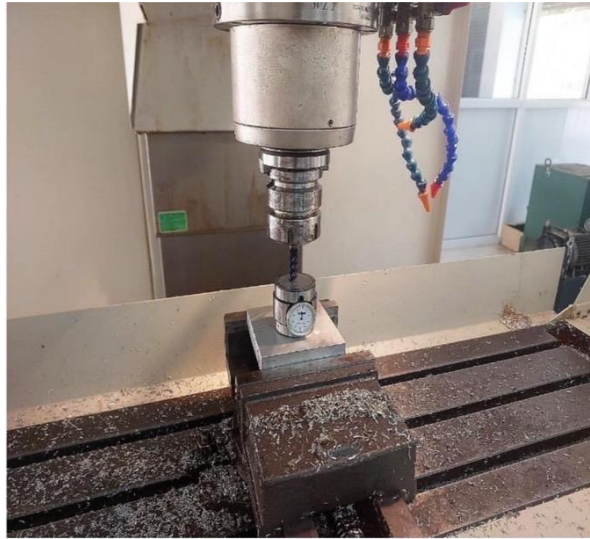
ดำเนินงานรูปภาพที่ 27 การตั้งค่าดอกกัดชิ้นงาน ( ที่มา : นายภาสกร หิงไธสง และคณะ, 2567 )
