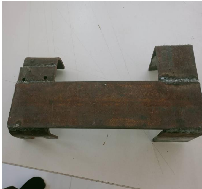
ภาพที่ 3.2 การติดตั้งโครงเหล็กจับฐานแกนหัว Spindle (ที่มา:นายจักรพันธ์ พลະดีและคณะ,2567)
