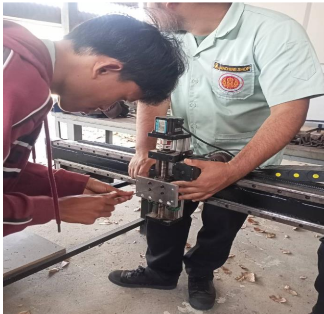
ภาพที่ 3.3 การติดตั้งแผ่นเพลทอลูมิเนียมตัวจับมอเตอร์สปีนเดิล (ที่มา:นายจักรพันธ์ พลະดีและคณะ,2567)
