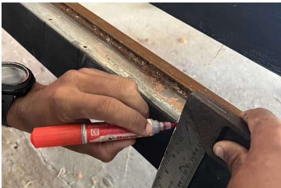
รูปภาพที่ 3.3 วัดหาระยะเพื่อที่จะติดตั้งเฟืองสะพาน ( ที่มา : วุฒิชัย สุขสัน,2567 )
