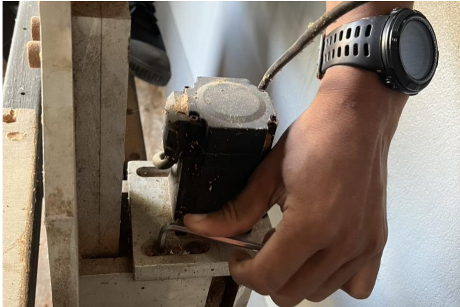
รูปภาพที่ 1 ถอดเซอร์โวมอเตอร์ ( ที่มา : วุฒิชัย สุขสัน,2567 )
