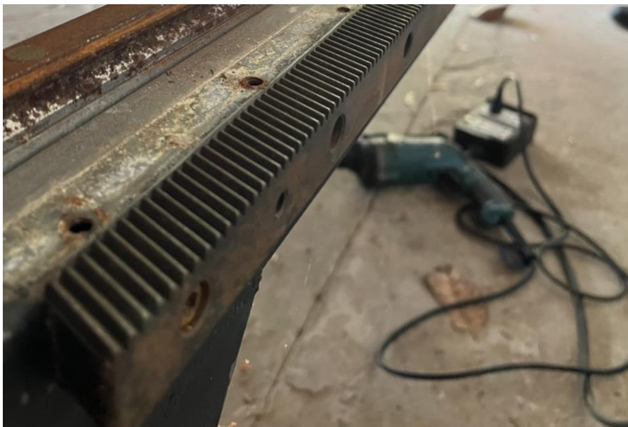
รูปภาพที่ 6 ใส่เฟืองสะพาน ( ที่มา : วุฒิชัย สุขลั่น,2567 )
