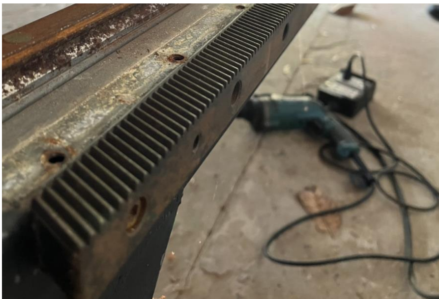
รูปภาพที่ 3.6 ใส่เฟืองสะพาน ( ที่มา : วุฒิชัย สุขสัน,2567 )
