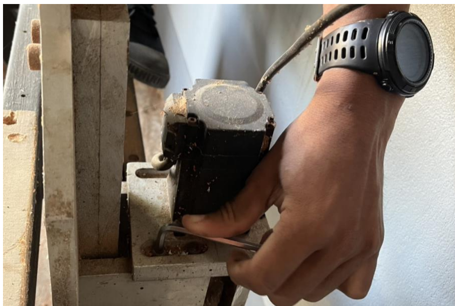
รูปภาพที่ 3.1 ถอดเซอร์โวมอเตอร์
