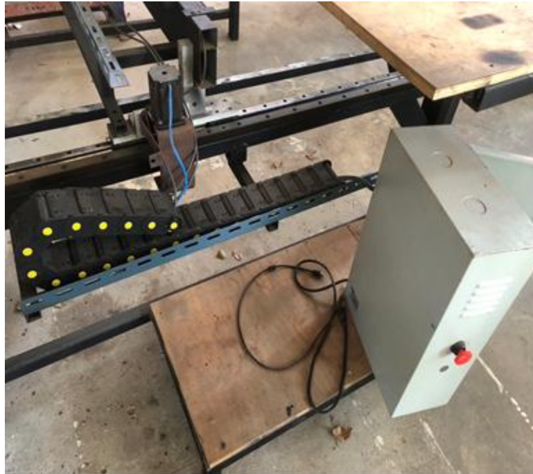
รูปภาพที่ 3 รางสายไฟ
