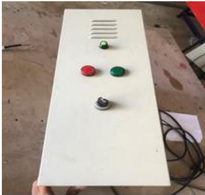
รูปภาพที่ 3.1 สวิตช์หมุนสีดำ : สวิตช์เปิด/ปิดใช้สำหรับเปิดหรือปิดการทำงานของเครื่องจักร
