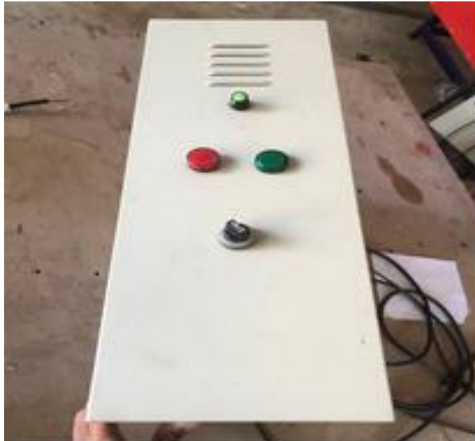
รูปภาพที่ 1 สวิตช์หมุนสีดำ : สวิตช์เปิด/ปิดใช้สำหรับเปิดหรือปิดการทำงานของเครื่องจักร (ที่มา : นายสนธยา บุรณ์เจริญและคณะ,2567)
