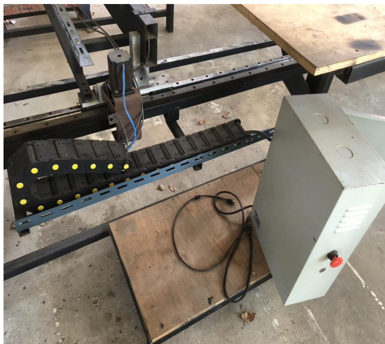
รูปภาพที่ 3.3 รางสายไฟ
