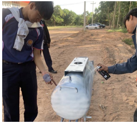
ภาพที่3.7 ลงสีรองพื้น และลงสีจริง
