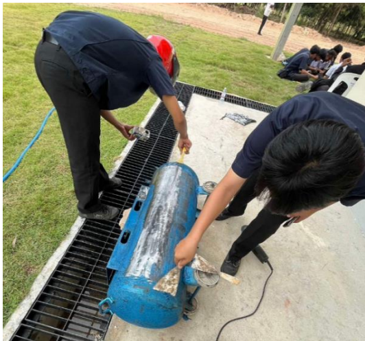
ภาพที่3.6 ล้างปั๊มลม ลอกสติกเกอร์ออก ขัดเศษฝุ่นออก และนำผ้าแห้งมาเช็ดให้แห้ง
