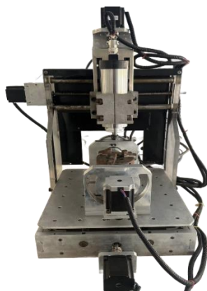
รูปภาพที่ 2.2 Fixed axis Milling ( แหล่งที่มา: สุริยะพันธ์ ดวงกุล และคณะ , พ.ศ. 2567 )
