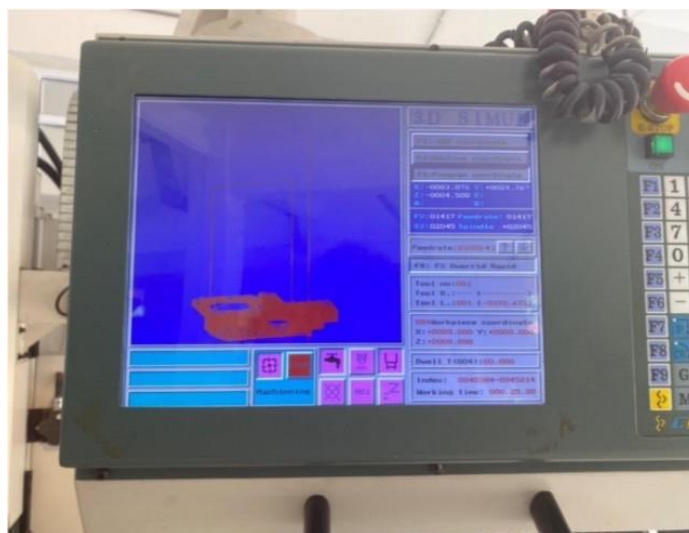
รูปภาพที่ 3.4.5 นำเข้า G-Code และจำลองเส้นทางการเดิน ( แหล่งที่มา: สุริยะพันธ์ ดวงกุล และคณะ , พ.ศ. 2567 )
