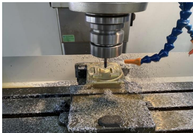
รูปภาพที่ 3.4.7 ฝ้าดูการกัดชิ้นงานและปรับค่าหากจำเป็น ( แหล่งที่มา: สุริยะพันธ์ ดวงกุล และคณะ , พ.ศ. 2567 )
