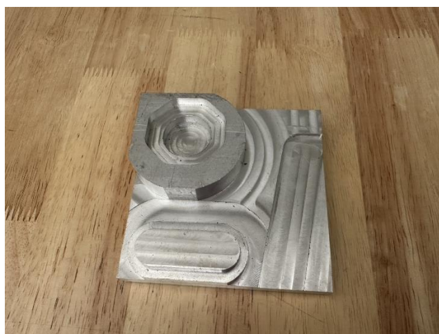
รูปภาพที่ 3.4.8 ชิ้นงานที่กัดเสร็จแล้ว ( แหล่งที่มา: กฤษฎกร หาหงษ์ และคณะ , พ.ศ. 2567 )
