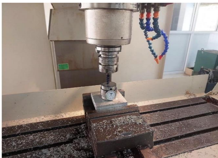
รูปภาพที่ 3.4.4 กำหนดระยะของดอกกัดกัดชิ้นงาน ( แหล่งที่มา: กฤษฎกร หาหงษ์ และคณะ , พ.ศ. 2567 )
