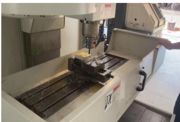
รูปภาพที่ 3.4.6 กดปุ่มเพื่อเริ่มเดินเครื่องทำการกัดชิ้นงาน ( แหล่งที่มา: กฤษฎกร หาหงษ์ และคณะ , พ.ศ. 2567 )
