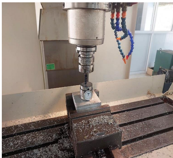
รูปภาพที่ 3.23 กำหนดระยะของดอกกัดกับชิ้นงานในแต่ละดอก (ที่มา : นายอนุพงษ์ สีแสง และคณะ,2567)
