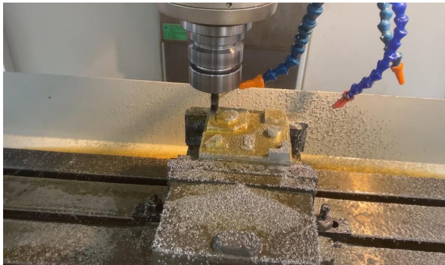
รูปภาพที่ 3.26 ฝ้าดูการกัดชิ้นงานและปรับค่าหากจำเป็น (ที่มา : นายอนุพงษ์ สีเสด และคณะ,2567)
