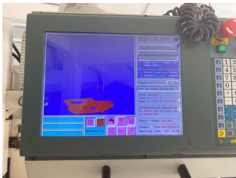
รูปภาพที่ 3.24 นำเข้า G-code และจำลองเส้นทางการเดิน (ที่มา : นายอนุพงษ์ สีแสง และคณะ, 2567)
