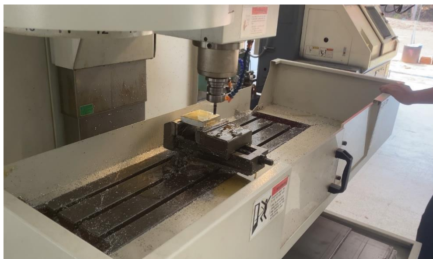
รูปภาพที่ 3.25 กดปุ่มเพื่อเริ่มเดินเครื่อง ทำการกัดชิ้นงาน (ที่มา : นายอนุพงษ์ สีแสง และคณะ, 2567)
