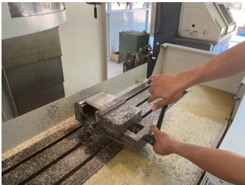
รูปภาพที่ 3.20 จับชิ้นงานด้วยปากกาจับชิ้นงาน (ที่มา : นายอนุพงษ์ สีเสต และคณะ,2567)
