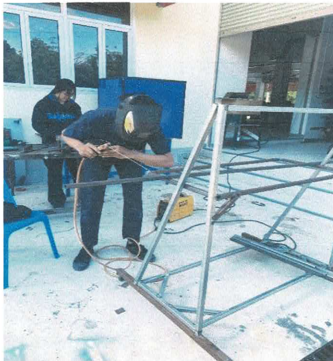
ภาพที่ 3.1.1 ขั้นตอนการเชื่อมทำโครงโต๊ะสำหรับวางชุดสื่อการสอนนิเวติกส์ ที่มา(นายพนพล ใจวิเศษ และคณะ,2567)
