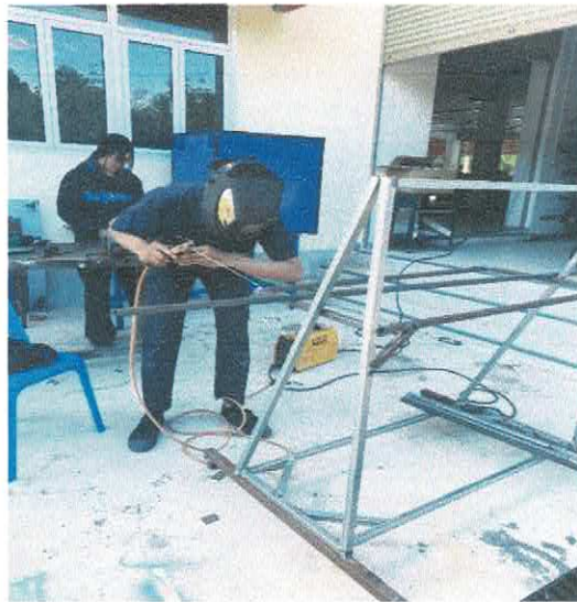
ภาพที่ 1 ขั้นตอนการเชื่อมทำโครงโต๊ะสำหรับวางชุดสื่อการสอนนิเวติกส์ ที่มา(นายนพดล ใจวิเศษ และคณะ,2567)
