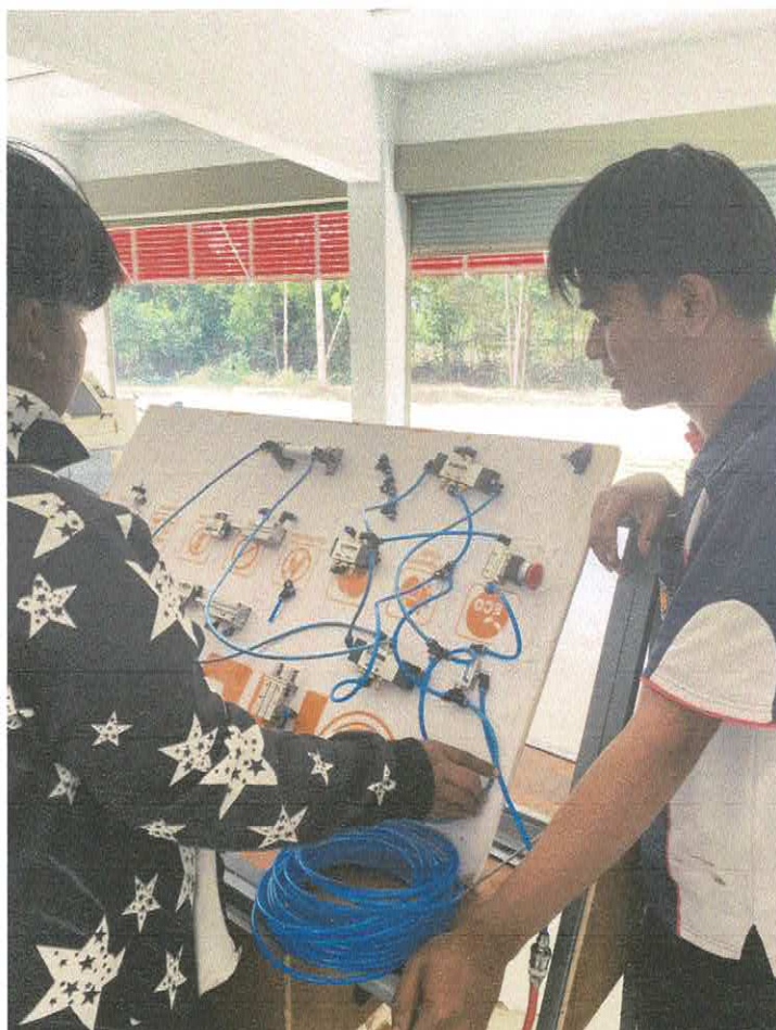
ภาพที่ 5 ขั้นตอนการต่อลมเข้าชุดสื่อการสอนนิวเมติกส์ ที่มา(นายพนพล ใจวิเศษ และคณะ,2567)
