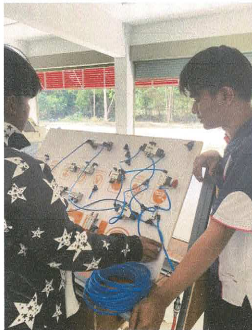
ภาพที่ 3.1.5 ขั้นตอนการต่อลมเข้าสู่ชุดสื่อการสอนนิวเมติกส์ ที่มา (นายนพดล ใจวิเศษ และคณะ,2567)
