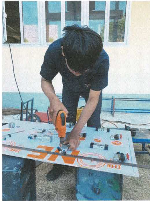
ภาพที่ 3.1.4 ขั้นตอนการยึดวาล์วและกระบอกสูบนิวเมติกส์ ที่มา(นายนพดล ใจวิเศษ และคณะ,2567)
