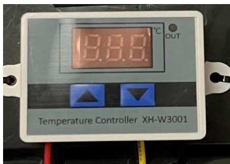
ภาพที่ 2.8 เครื่องควบคุมอุณหภูมิ
