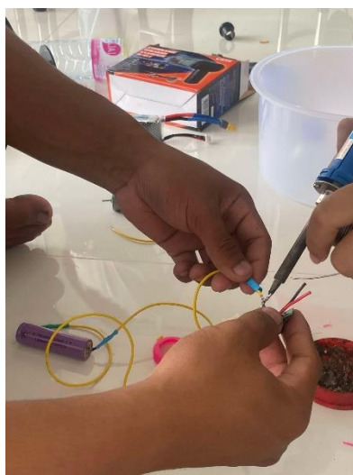
ภาพที่ 3.4 ปิดกรีสายอุปกรณ์ทั้งหมด
