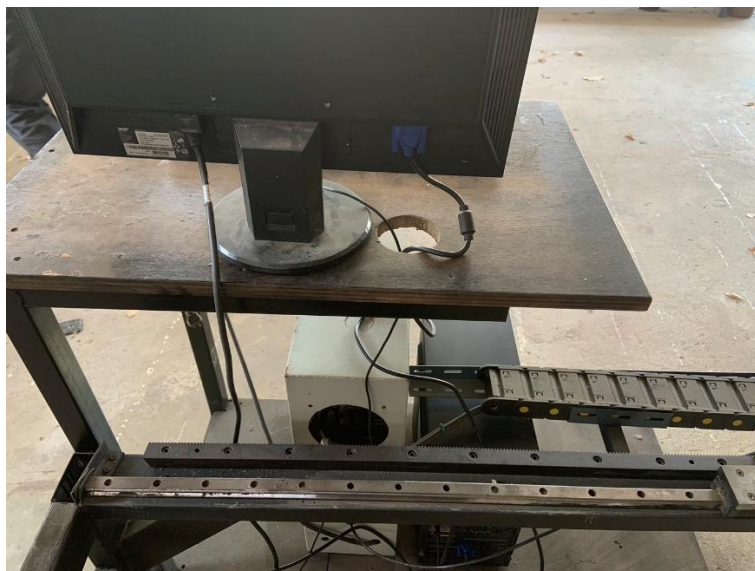
ภาพที่ 4.2 เสียบสายอุปกรณ์คอมพิวเตอร์ นำสาย USB ของตู้ควบคุม (สายสีฟ้า) เสียบเข้ากับช่อง USB ของ เครื่องคอมพิวเตอร์ แล้วเสียบปลั๊กไฟเครื่องคอมพิวเตอร์และปลั๊กไฟของตู้ควบคุม แล้วเปิดเครื่องคอมพิวเตอร์ ที่มา : ชัยวัฒน์ สวयरูป และคณะ 2568
