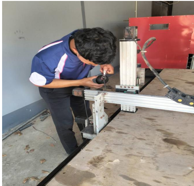
รูปภาพที่ 4 หยอดน้ำมันที่รางสไลด์เพื่อป้องกันการเกิดสนิม ( ที่มา: นิธิศ จันทะคาม และคณะ2568 )
