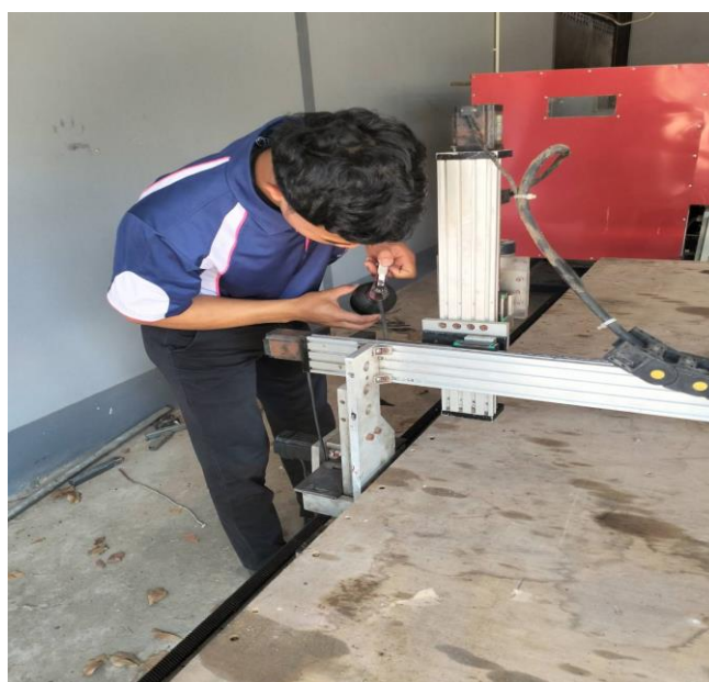
รูปภาพที่ 2.14 หยอดน้ำมันที่รางสไลด์เพื่อป้องกันการเกิดสนิม ( ที่มา: นิธิศ จันทะคาม และคณะ2568 )
