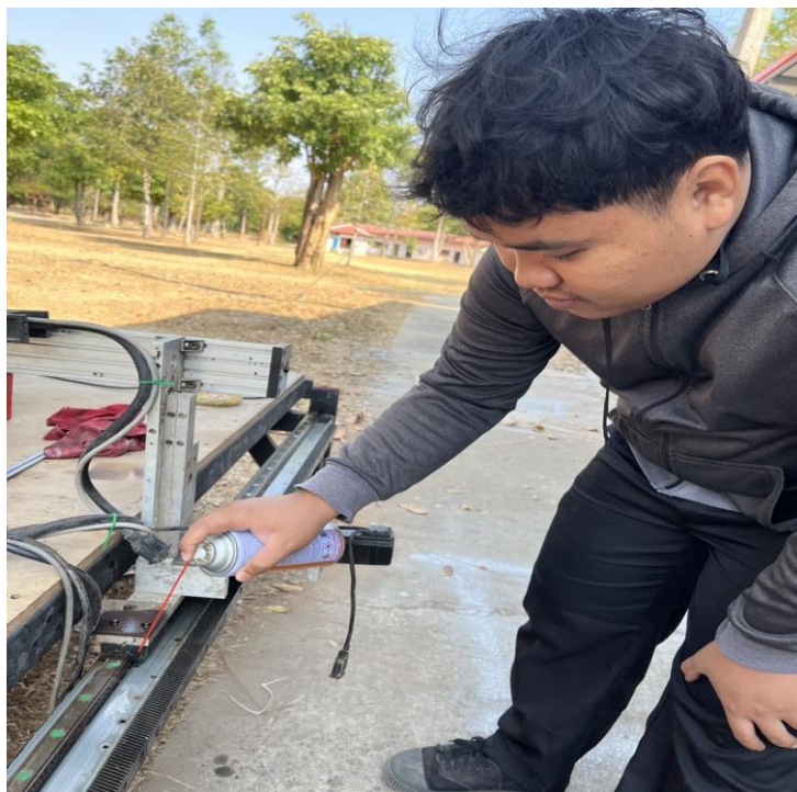
รูปภาพที่ 2.11 ใช้ Sonax ฉีดลงในรางสไลด์ที่เกิดสนิม ( ที่มา: นิธิศ จันทะคาม และคณะ2568 )
