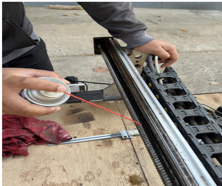
รูปภาพที่ 2 ใช้ Sonax ฉีดตรงจุดที่เกิดสนิม ( ที่มา: นิธิศ จันทะคาม และคณะ2568 )
