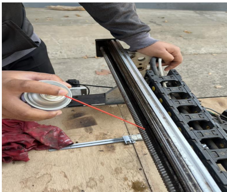
รูปภาพที่ 2.12 ใช้ Sonax ฉีดตรงจุดที่เกิดสนิม ( ที่มา: นิธิศ จันทะคาม และคณะ2568 )
