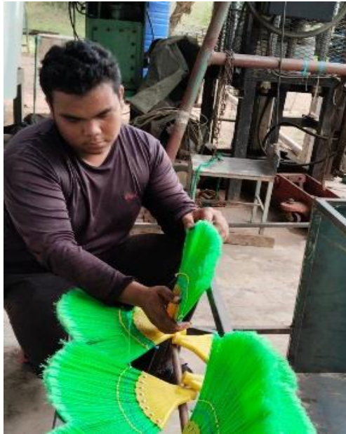
ภาพที่3. ใส่ไม้กวาดที่เพลลา เพื่อทำหน้าที่กวาดเศษใบไม้และกิ่งไม้ขนาดเล็ก
