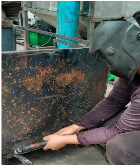
ภาพที่ 2.ดำเนินการเชื่อมแผ่นเหล็กใส่รถกวาดใบไม้
