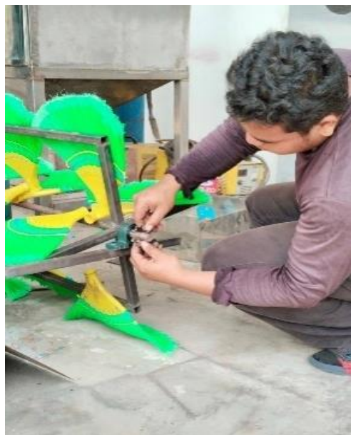
ภาพที่ 4.การดำเนินการใส่สเตอร์เพื่อเป็นจุดหมุน สำหรับกวาดเศษใบไม้และกิ่งไม้ขนาดเล็ก
