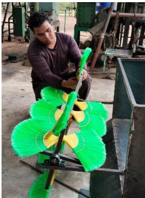
ภาพที่ 7.ใส่ไม้กวาดที่เพลลา เพื่อทำหน้าที่กวาดเศษใบไม้และกิ่งไม้ขนาดเล็ก
