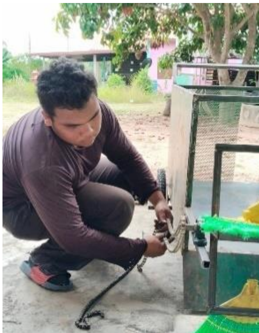
ภาพที่ 6.การดำเนินการใส่โซ่และสเตอร์เพื่อใช้ในการขับเคลื่อน
