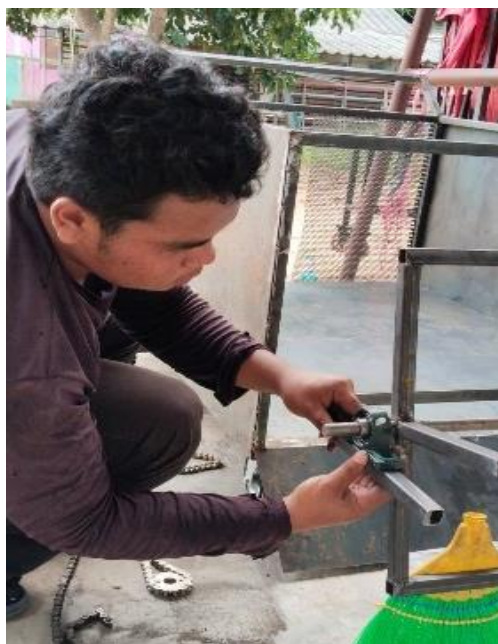
ภาพที่ 5.การดำเนินการใส่ตุ๊กตาเพลลาเพื่อเป็นจุดหมุน สำหรับกวาดเศษใบไม้และกิ่งไม้ขนาดเล็ก
