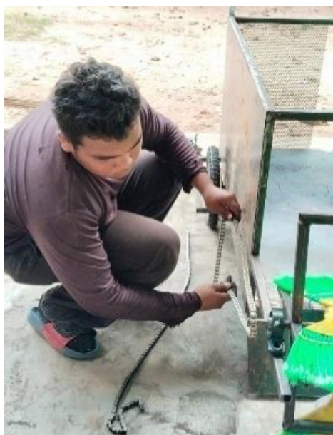
ภาพที่ 8.การดำเนินการใส่โซ่ สำหรับกวาดเศษใบไม้และกิ่งไม้ขนาดเล็ก
