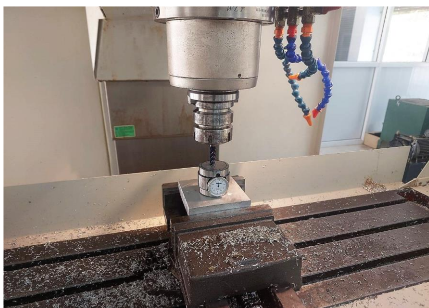
ภาพที่ 3.32 กำหนดระยะของดอกกัดกับชิ้นงานในแต่ละดอก (ที่มา : นายยมนาท สารศรี และคณะ,2567)
