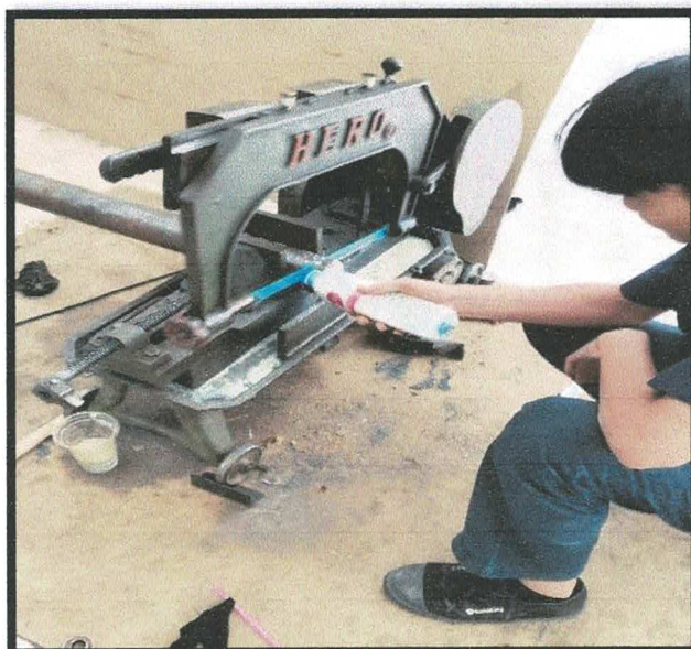
รูปที่ 3.2 การตัดเหล็ก (ที่มานายยศวรธรณ์ แดนกาไสยและคณะ 2567)
