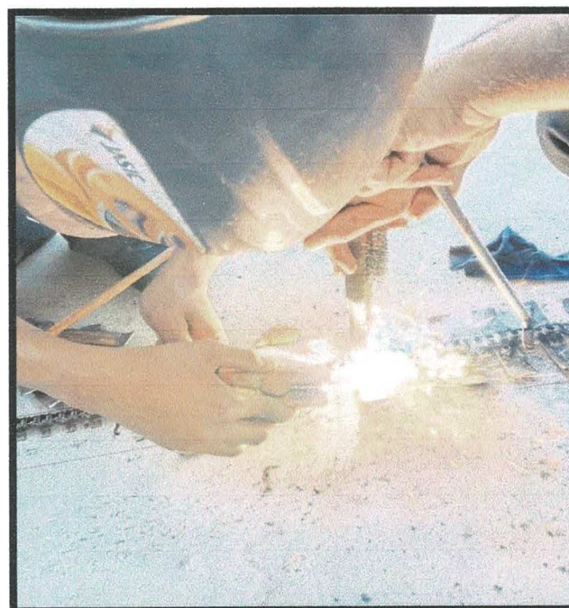
รูปที่ 3.7 เชื่อมไบแทร์ก (ที่มา: นายยศวรธรณ์ แดนกาไสยและคณะ 2567)
