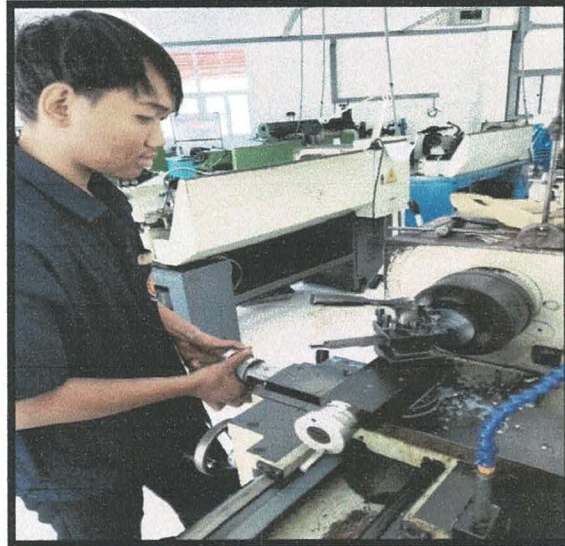
ภาพดำเนินงานที่ 5 ทำการกลึงชิ้นงาน (ที่มา: นายยศวรธรณ์ แदनกาไสยและคณะผู้จัดทำ 2567)
