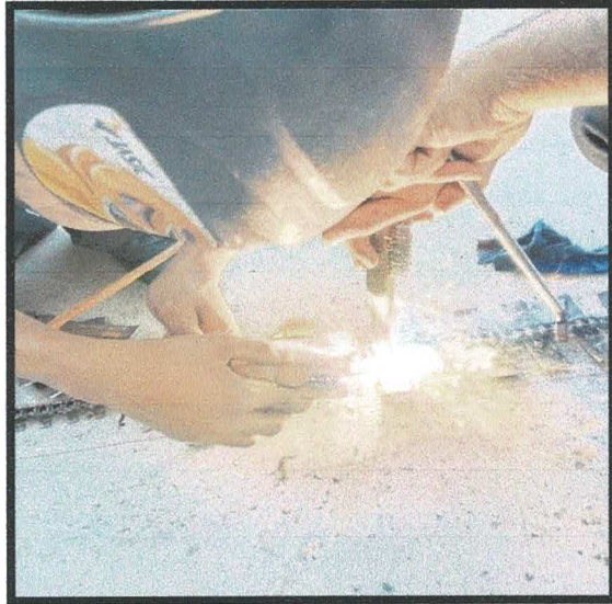
ภาพดำเนินงานที่ 3 ทำการเชื่อมใบแพค (ที่มา: นายยศวรธรณ์ แดนกาไสยและคณะผู้จัดทำ 2567)
