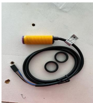
ภาพที่ 2.9 เซ็นเซอร์ตรวจจับวัตถุ photoelectric switch
