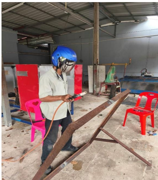
รูปภาพที่ 5 แสดงการเชื่อมเหล็กเพื่อขึ้นโครงชิ้นงาน
