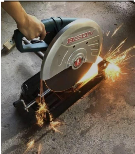
รูปภาพที่ 4 แสดงการนำเหล็กมาตัดเพื่อขึ้นชิ้นงาน
