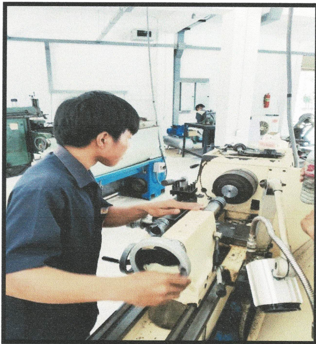
รูปที่ 3.3 การกลึงเหล็กยึดเพลลาเข้ากับสเตอร์ (ที่มานายณัฐพล พิลัย พร้อมคณะผู้จัดทำ 2567)
