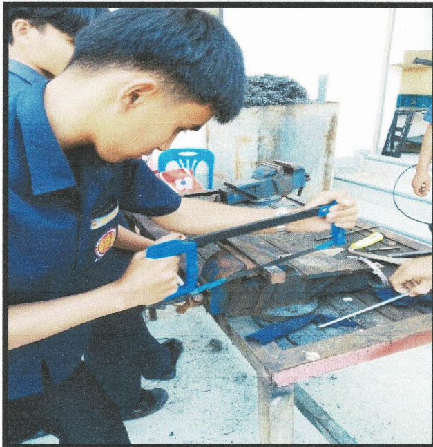
รูปที่ 3.5 ตัดเหล็กสำหรับการเชื่อม (ที่มานายณัฐพล พิลัย พร้อมคณะผู้จัดทำ 2567)
